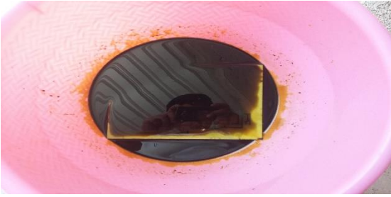
Figura 3.21 quitado de cobre con cloruro férrico
