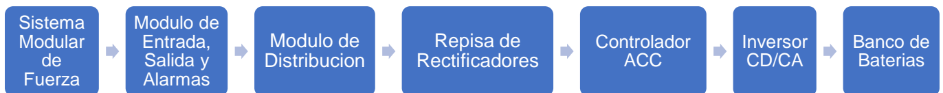
Figura 3.4 Diagrama de bloques de todo el Sistema de Fuerza
