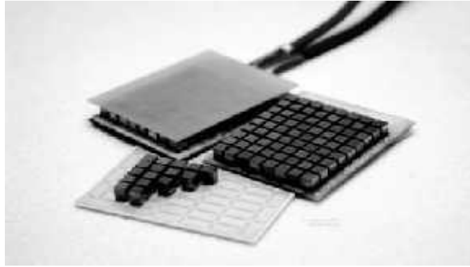
Figura 2.3 Estructura interna de un módulo termoeléctrico comercial
