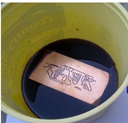
Imagen 3.11 proceso de relevado con cloruro Férrico
