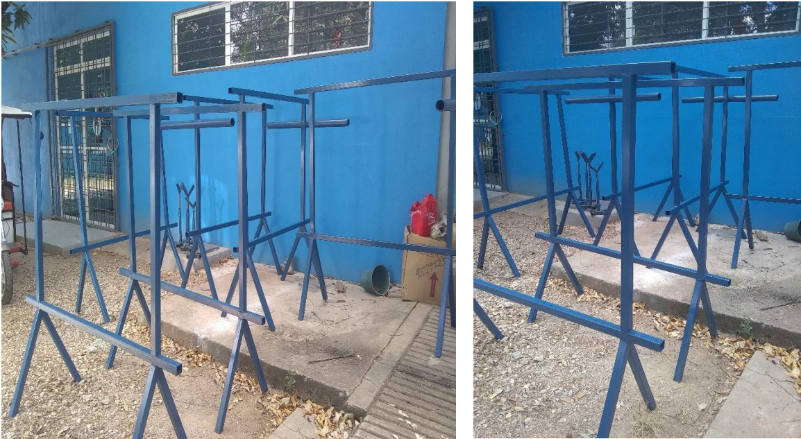
Figura 25. Soportes diseñados para para la ampliación a dos pisos de la planta piloto e instrumentación
