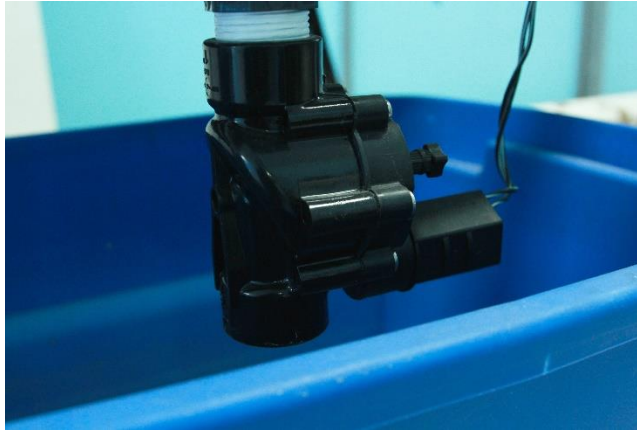
Figura 16 electroválvula del sistema serpentín.
