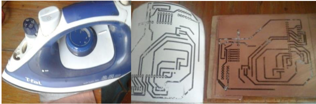
Imagen 3.3.11 circuito resultante usando la técnica de planchado
