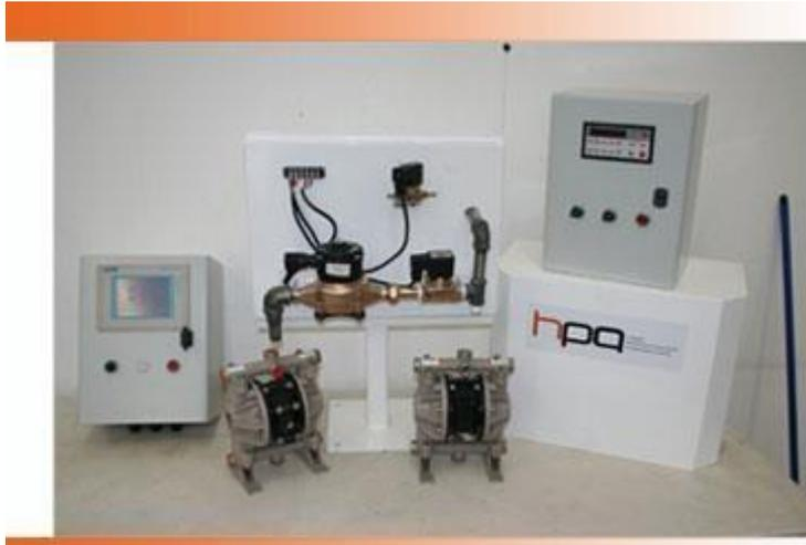
Figura 13. Sistema de Dosificación de Aditivos HPA
