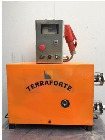
Figura 11. Sistema de Dosificación de Aditivos Terraforte con recubrimiento
