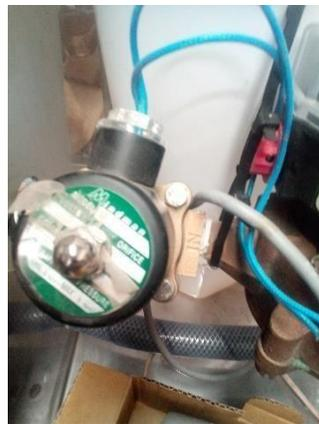
Figura 20. Montaje de Válvula de 2 vias
