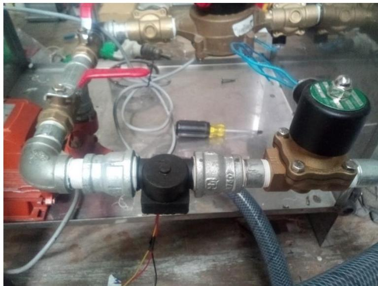
Figura 30. – Conexión con caudalímetro FS300A
