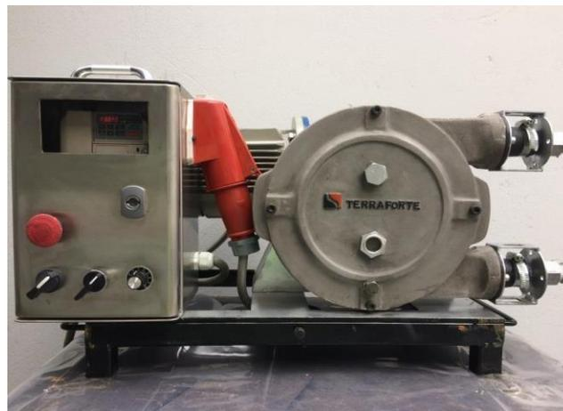
Figura 12. Sistema de Dosificación de Aditivos Terraforte sin recubrimiento
