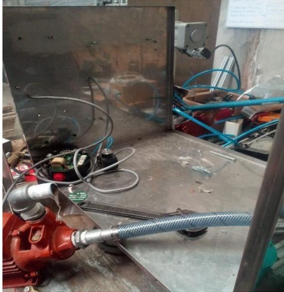
Figura 19. Montaje de Motor Centrifugo y tuberías
