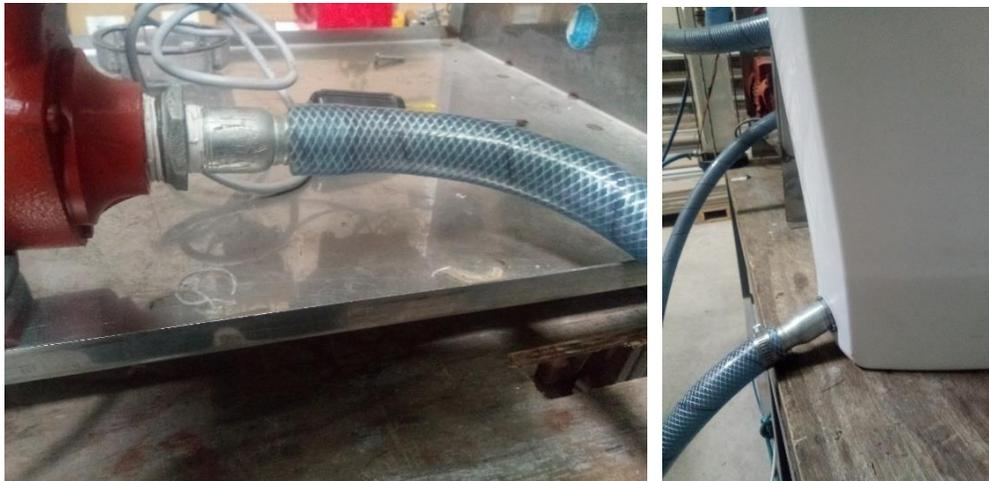
Figura 32. Acople para la entrada de fluido al motor
