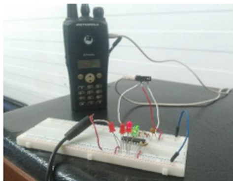
Figura 4.6: prueba de la radio y el TDMF para generar tonos.
