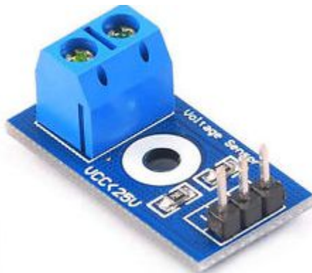
Figura 3.12: Sensor de voltaje FZ0430
