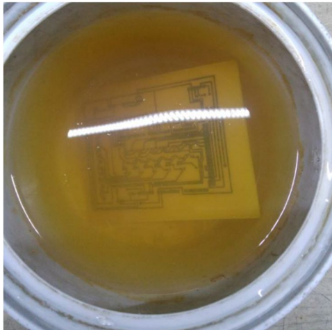
Figura 4.29: Lavado para quitar el cloruro férrico.
