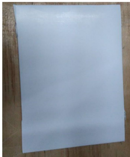
Figura 4.25: Placa cubierta con el papel Couche.
