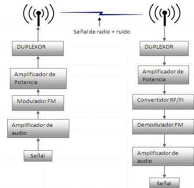
Figura 2.1: Diagrama del Sistemas VHF Analógico.
