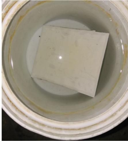
Figura 4.27: Eliminación del papel Couche de la placa.
