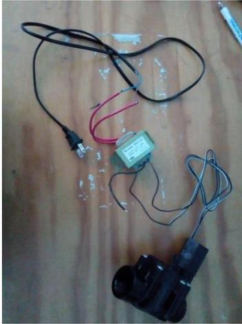
*Figura 3.8 Conexión para probar el funcionamiento de la electroválvula*
