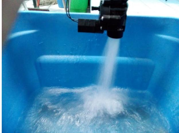
*Figura 3.9 Electroválvula funcionando correctamente*
