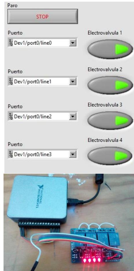
Figura 3.13 Activación de las cuatro electroválvulas al mismo tiempo
