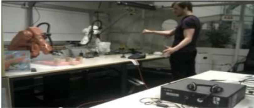
Figura 2.1 Robot ABB moviendo piezas de madera, controlado por Kinect [1].
