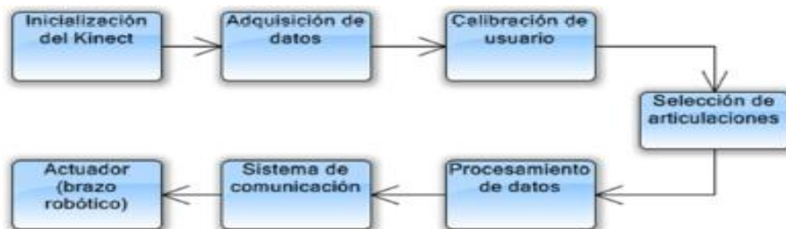
Figura 3.13 Diagrama a bloques de las etapas del sistema.
