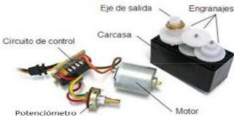
Figura 3.9 Elementos que conforman un servomotor [16].
