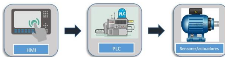
Figura 25. Diagrama de bloque de una HMI.
