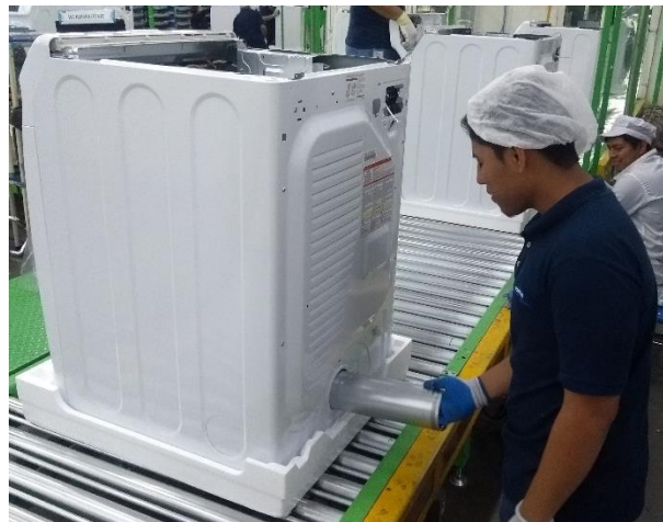
Figura 8. Ensamble manual del Duct Exhaust.
