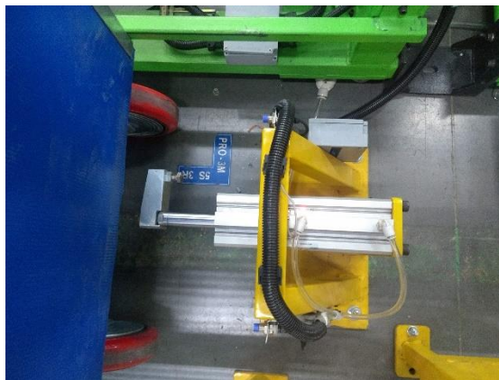
Figura 47. Sistema de sujeción del rack.
