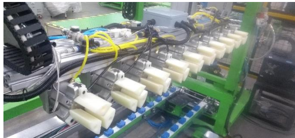
Figura 44. Barra con grippers neumáticos.
