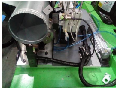
Figura 88. Posicionamiento del Duct Exhaust para toma de robot.
