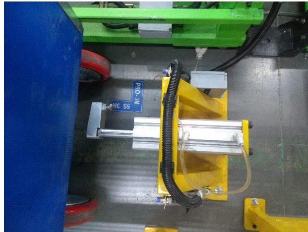
Figura 86. Sistema de sujeción de rack.
