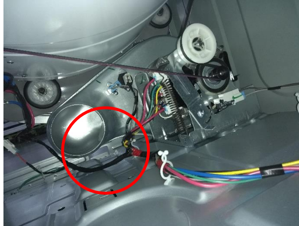
Figura 91. Problema de harnees dentro de secadora.
