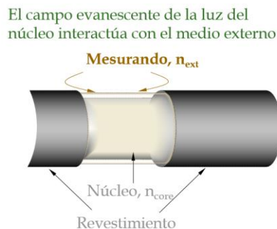
Figura 2.5. Representación de una fibra multimodo adelgazada mediante ataque químico. El revestimiento es totalmente removido en una sección de la fibra óptica de tal manera que en esa región solamente se tiene el núcleo. El campo evanescente se extiende fuera de la fibra óptica por lo que la transmisión de la luz en esta fibra está fuertemente determinado por el medio externo.
