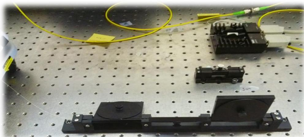
**Fig. 5.8. Montaje de los polarizadores para la entrada de cada sensor.**
