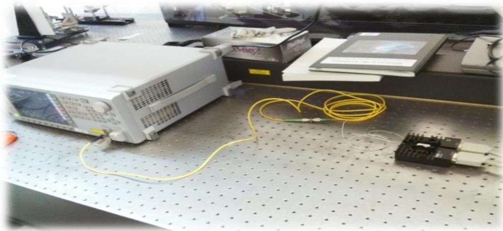
**Fig.5.7. Conexión del diodo superluminiscente al analizador para tomar la señal de referencia**
