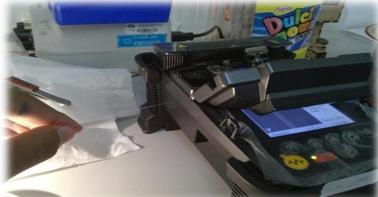
Fig. 5.4. Utilización de la empalmadora con una fibra óptica.
