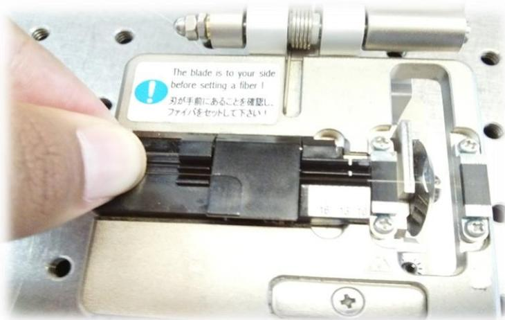
Fig.5.5. Manejo de la cortadora con la fibra multinúcleo.
