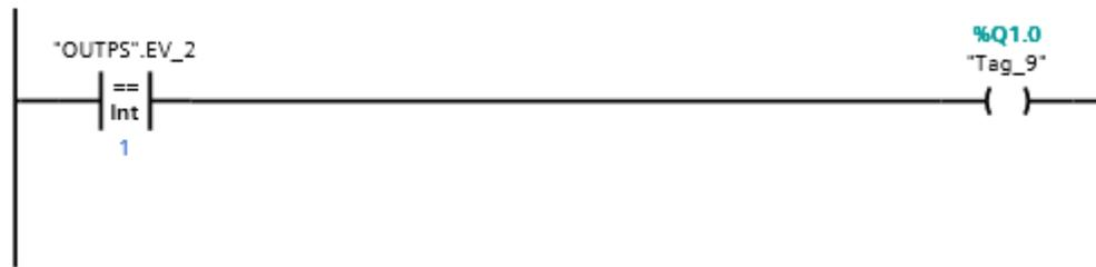
Ilustración 84 Activación electroválvula 2.
