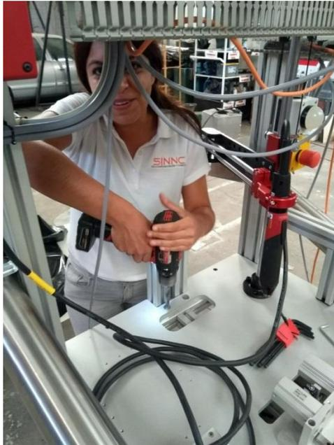
*Ilustración 105. Barreno para cableado.*
