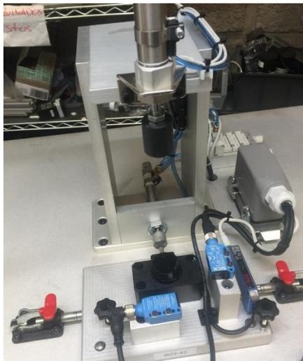
6. Si los sensores láser se desactivan se activará P3 dejando una marca en la pieza, indicando un ensamble correcto.
