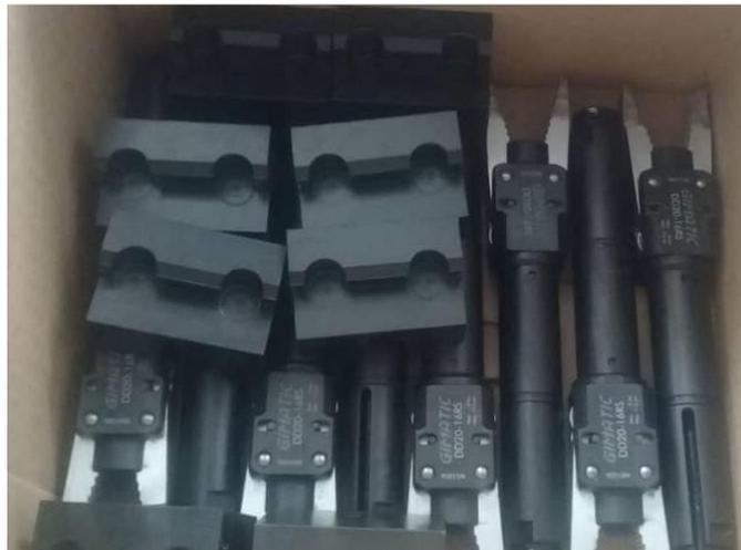
*Ilustración 10. Maquinados después de tratamiento de material.*
