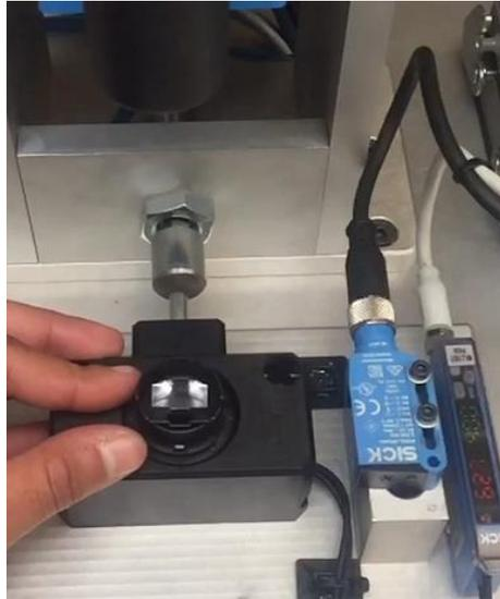
2. Colocar el bisel de la versión correspondiente sobre el housing. El sensor de fibra óptica deberá detectar la guía de luz, ya sea en el housing o bisel. (Cuando hay ausencia de guía de luz el sensor de fibra óptica da cantidades muy pequeñas a diferencia de cuando detecta una guía de luz).
