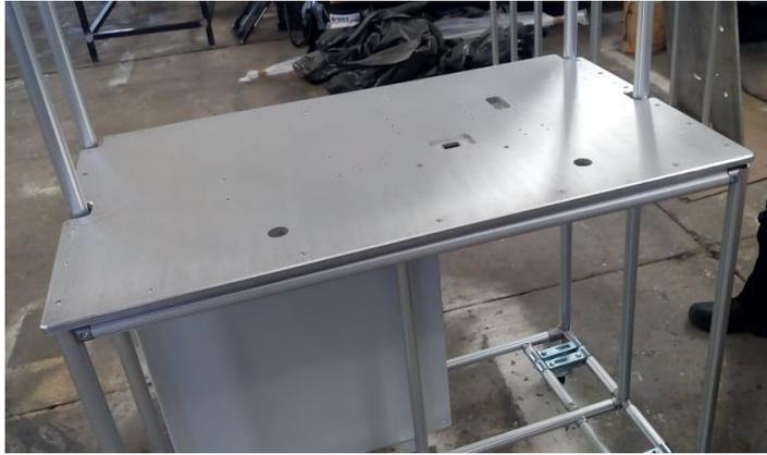
*Ilustración 12. Placa de acero inoxidable colocada como área de trabajo de la estación U611.*
