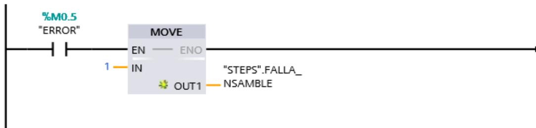
Ilustración 72. Activación variable NSAMBLE (error de ensamble) mediante una marca de error.
