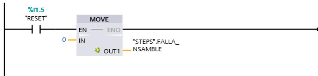
Ilustración 74. Activación de fallo de ensamble por reset.
