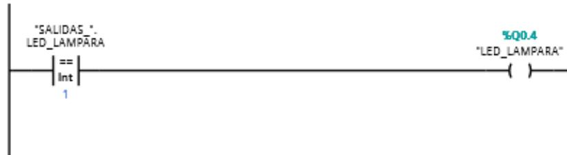
Ilustración 31. Salida lámpara superior U611-1.
