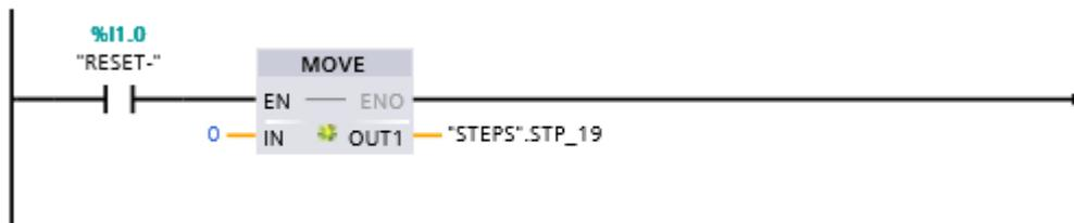
Ilustración 70. Activación botón reset.
