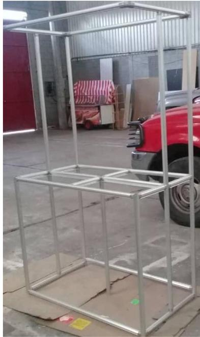
*Ilustración 11. Estructura estación ensamble U611, perfiles tubulares.*
