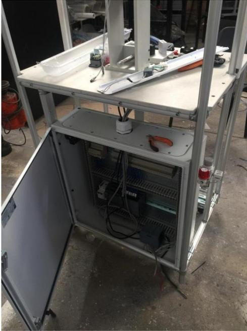
*Ilustración 104. Construcción panel de control.*
