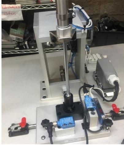
5. Los sensores láser deberán desactivarse después de realizar el ensamble, y así el pistón P2 retorna a su posición de inicio.
