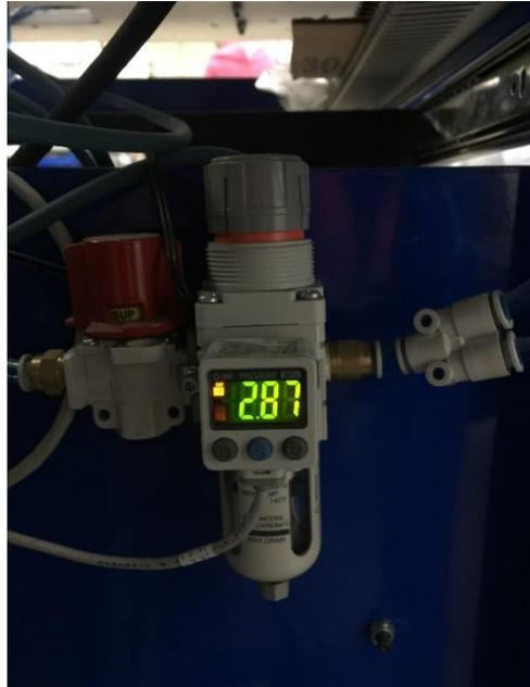
*Ilustración 107. Sensores presión de aire ISE40A.*
