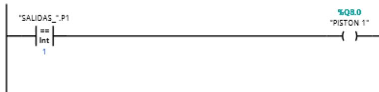
Ilustración 37. Salida pistón 1 ensamble guía de luz.
