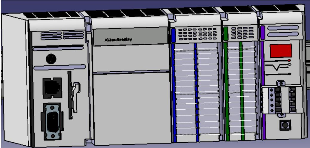
Fig. 4.63: Paso 6 PLC CompactLogix L32E con módulos
