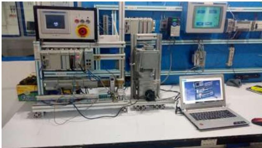
Fig. 5.4: PCL, variador de frecuencia, motor, encoder funcionando
