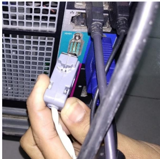
Fig. 3.62 Conexión cable OPCA-02 al PC
