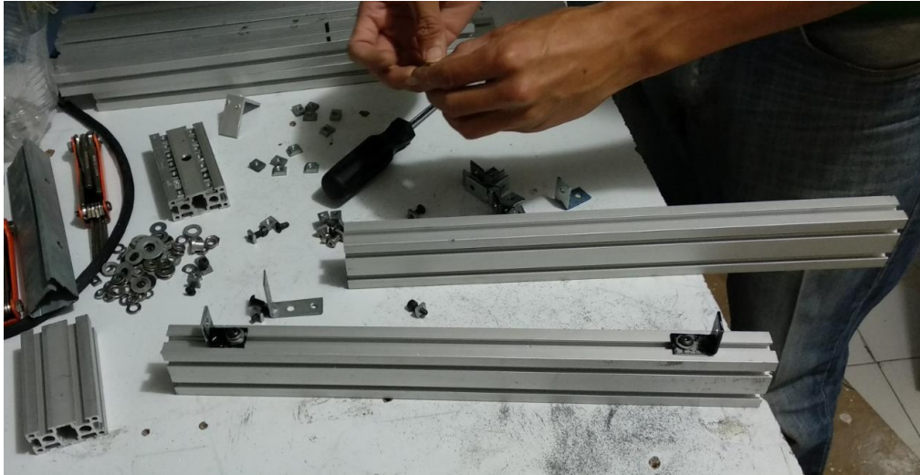
Fig. 3.11 Colocando pletinas y tornillos
