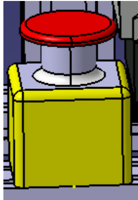
Fig. 3.4.12 Diseño Pulsador de emergencia
