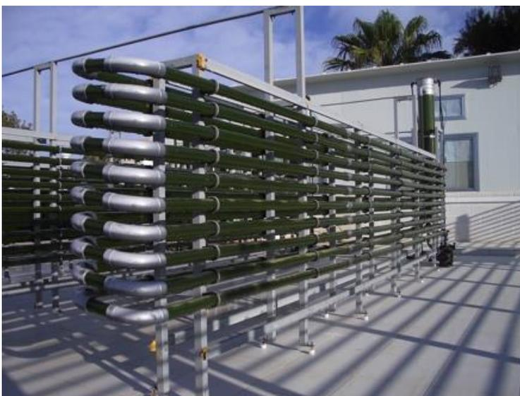
**Figura 5.0 Fotobiorreactor de Tipo tubular**
