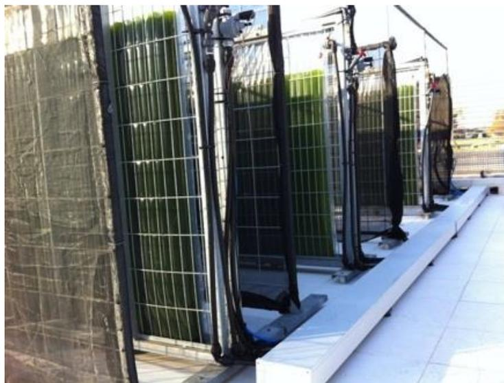
**Figura 4.0 Fotobiorreactor de Tipo panel**
