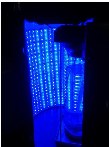
**Figura 17.0 Instalación de LEDS al Fotobiorreactor**
