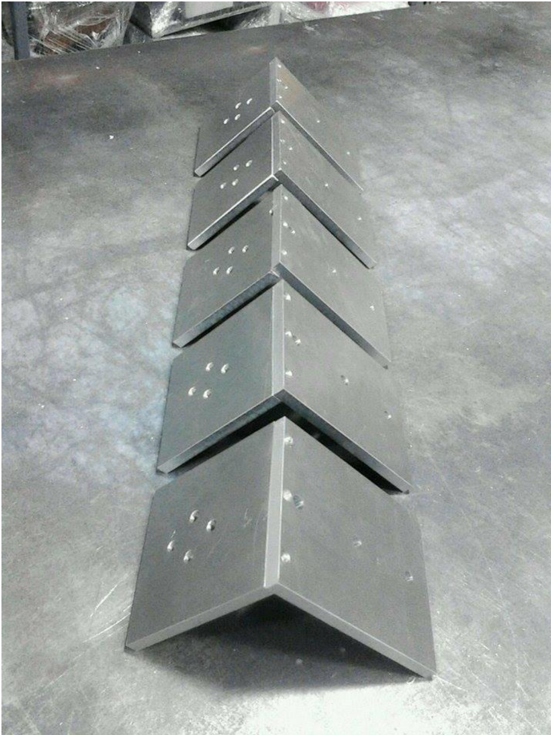
Fig. 56 Bases para cinco máquinas automáticas
