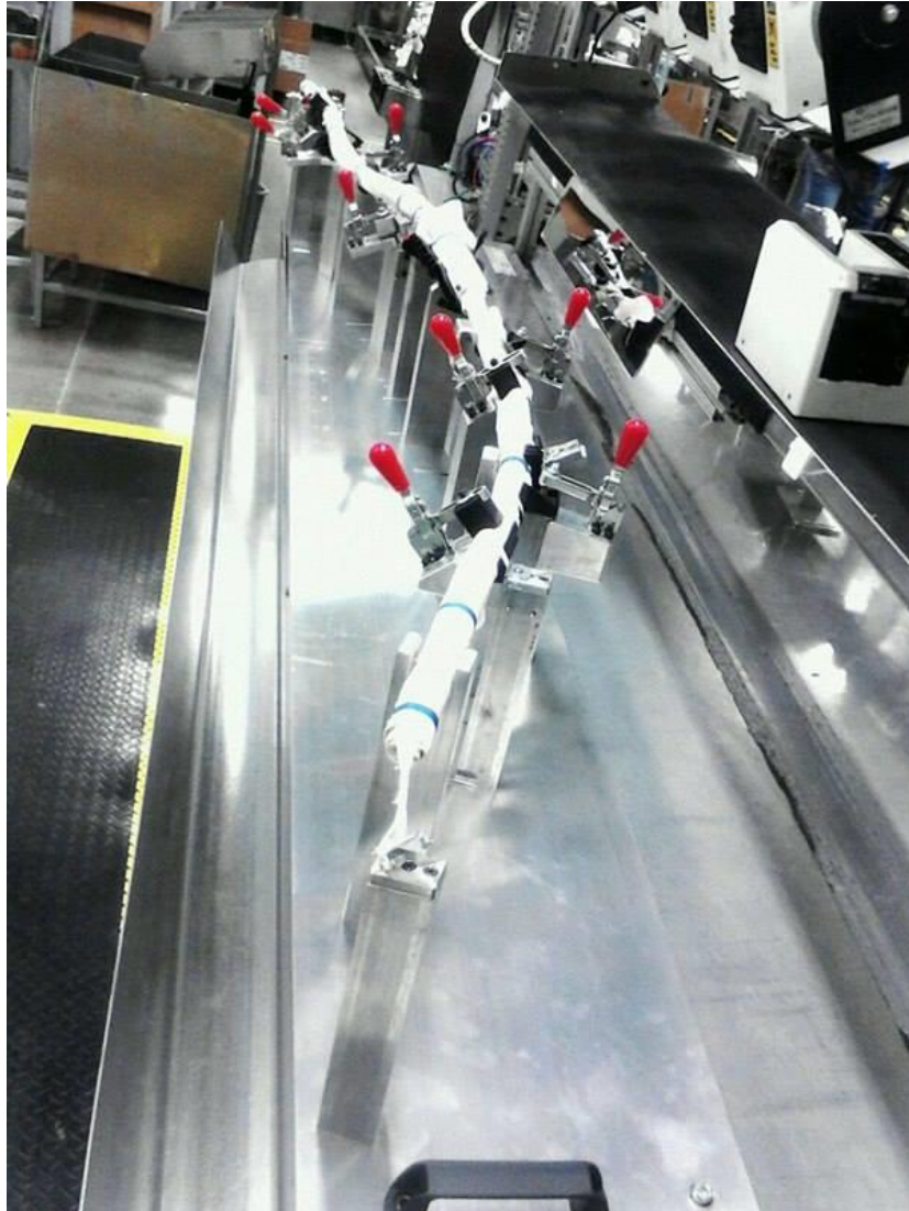
Fig. 37 Fixture para ver si la cortina se encuentra dentro de sus parámetros
