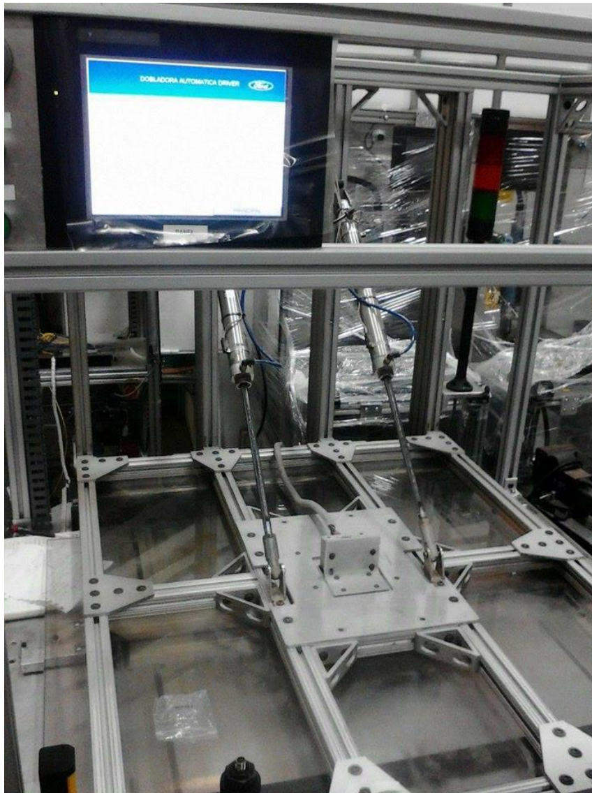
Fig. 44 Colocación de HMI
