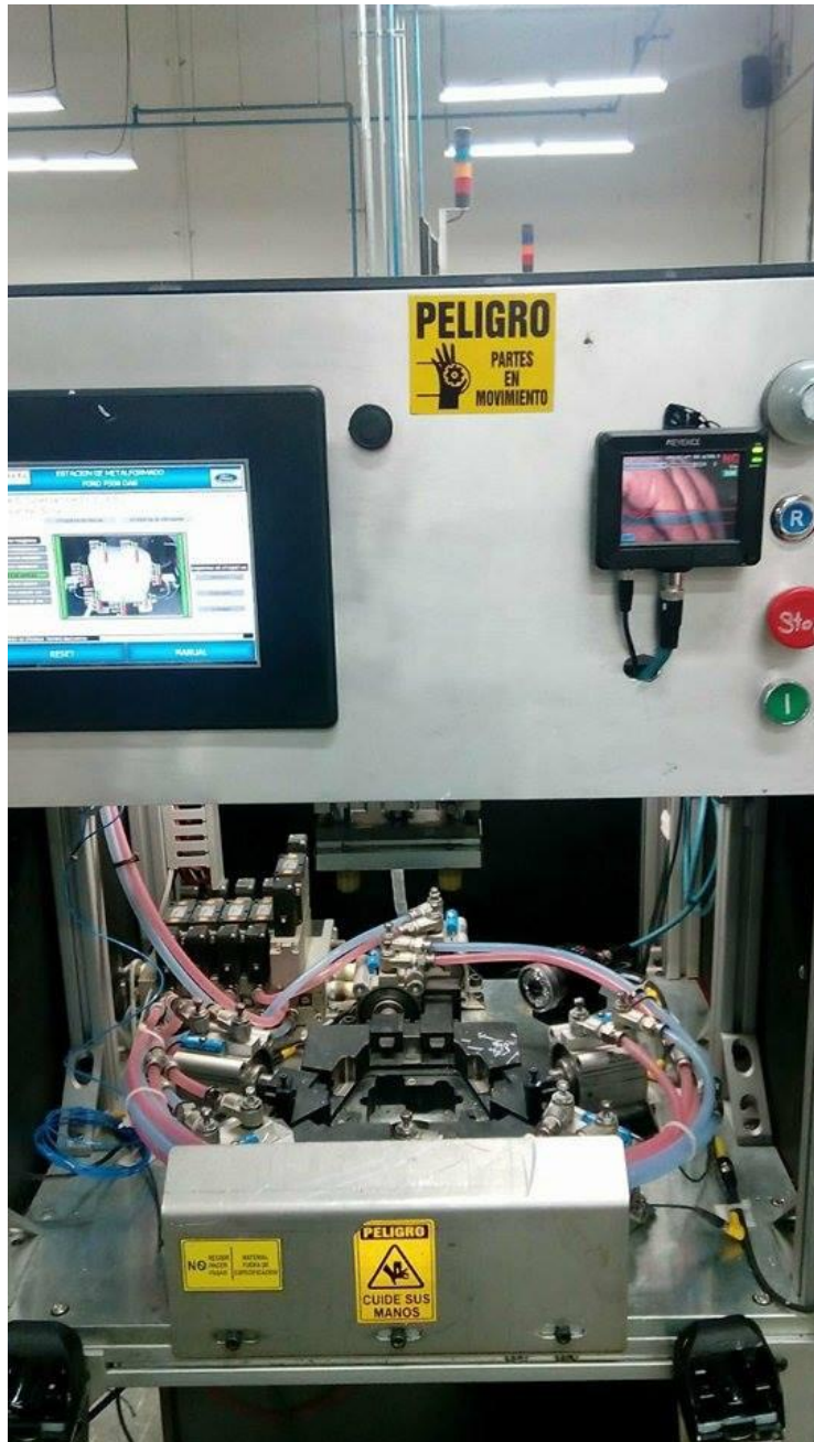
Fig.58 maquina con cámara CV-500CA para asi checar la altura de la bolsa ya comprimida
