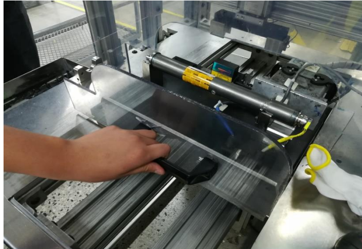
Fig. 27 fixture que checa continuidad del inflador
