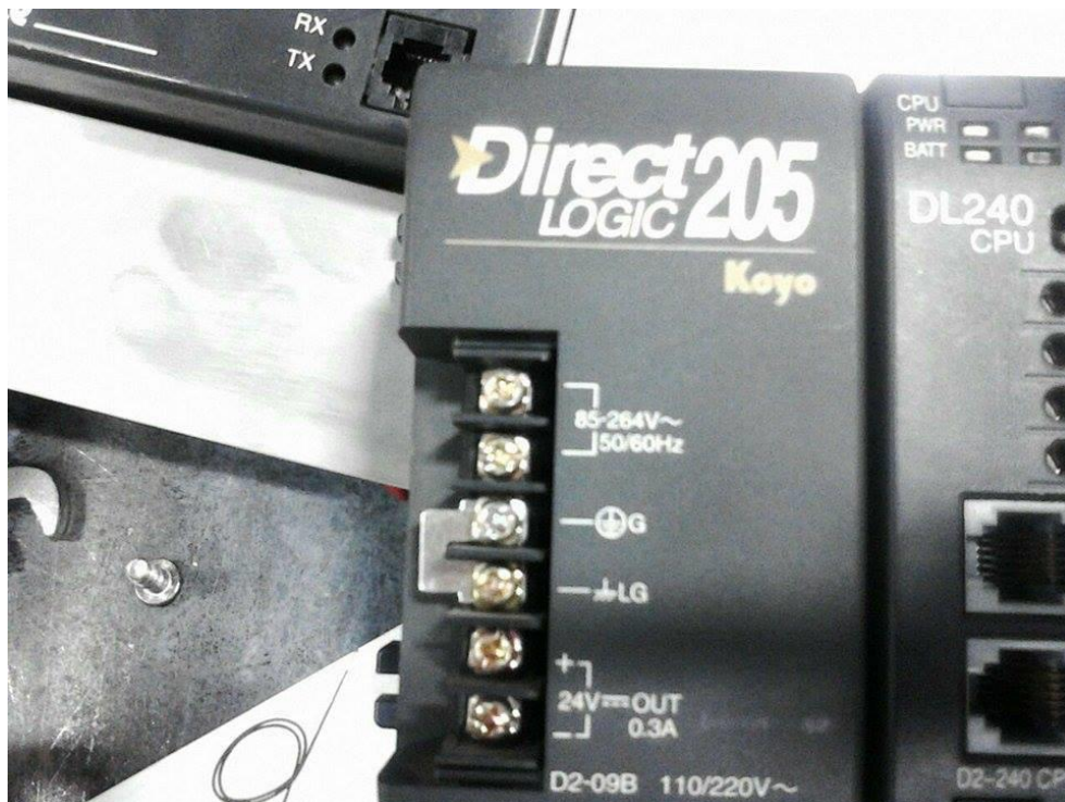
Fig. 41 PLC Direct Logic 205 dañado
