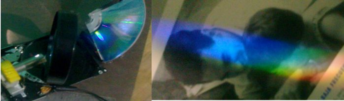
Figura 3.3.1 experimento número 1 funcional que corresponde a la construcción del dispersor. Como se puede apreciar si separa la luz blanca en sus diferentes longitudes de onda.
