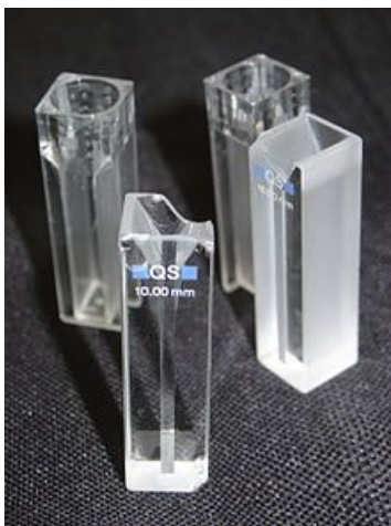
Figura 2.20.1.1 Celdas de espectrofotometría. En un primer plano, dos de cuarzo aptas para el trabajo con luz ultravioleta; en segundo plano, de plástico, para colorimetría (es decir, empleando luz visible).
