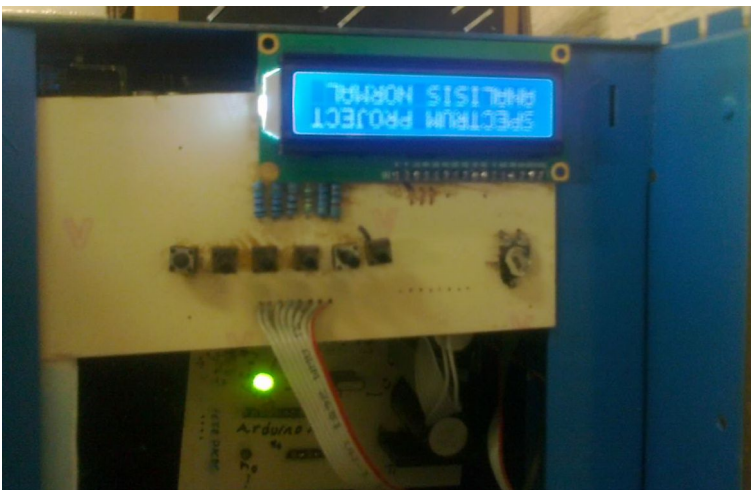
Figura 3.7.3 prototipo funcionando con los botones de selección de opciones y se puede apreciar la función seleccionada en la LCD.
