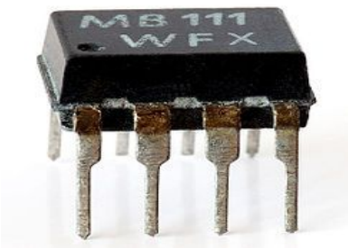
Figura 2.16.1 encapsulado de un optoacoplador con salida de transistor y simbolo electronico.
