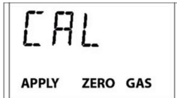
Figura 25.- Visualización en la pantalla para suministrar el gas de puesta a cero.
