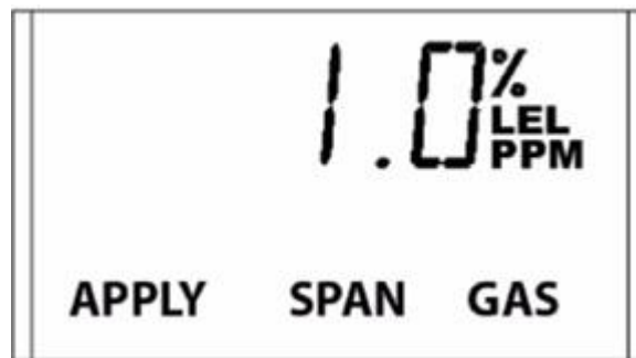
Figura 26.- Visualización en la pantalla para suministrar el gas de prueba.
