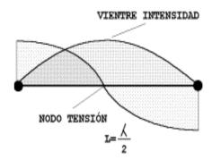
La separación entre las dos varillas será la menor posible y constante en toda la antena, pues se consigue mayor ancho de banda al ser mayor la superficie de radiación. Por otra parte, bajo el punto de vista eléctrico es inútil utilizar elementos macizos con altas frecuencias, puesto que la corriente circula por la superficie (efecto pelicular).
