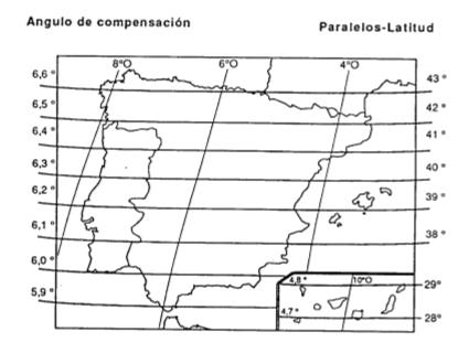
El ángulo de elevación es el primer ajuste que debemos realizar. Con ayuda de un instrumento, llamado inclinómetro, ajustaremos la elevación de la parábola teniendo en cuenta la latitud más el ángulo de compensación en el lugar que nos encontremos
