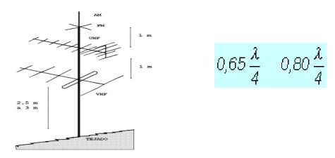
Se puede colocar un circuito oscilante a la entrada del televisor, que es un cable bifilar o coaxial de longitud/4 de la señal que interfiere.
