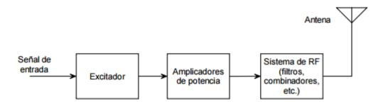
En la figura anterior, el excitador contiene, básicamente, al modulador, cuya salida es una señal modulada a la frecuencia de la portadora o a alguna frecuencia intermedia, en cuyo caso, contiene también un conversor ascendente para trasladar la señal en FI a la frecuencia de la portadora del canal de RF. En los transmisores digitales, el modulador puede incluir también al codificador de canal.
