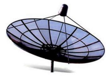
Para recibir las emisiones procedentes de un satélite, es necesario la instalación de una antena parabólica exterior de 30 cm a 1,80 de diámetro, añadirle un convertidor, que convierte la señal de 11 GHz a 1 GHz, así como un polarizador, capaz de separar las señales polarizadas horizontalmente de las polarizadas en sentido vertical. Si esta antena dispone de un posicionador, podemos captar varios satélites.
