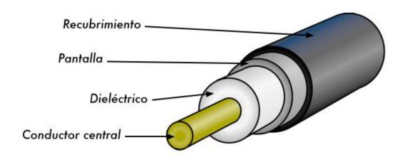
La pérdida (o atenuación) de un cable coaxial depende de la construcción del cable y de la frecuencia de operación. La pérdida total es proporcional a la longitud del cable.
