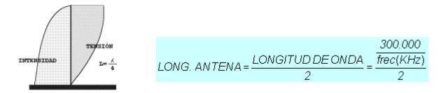
La longitud exacta de las antenas es un 5 % menor, debido a aislamientos defectuosos.
