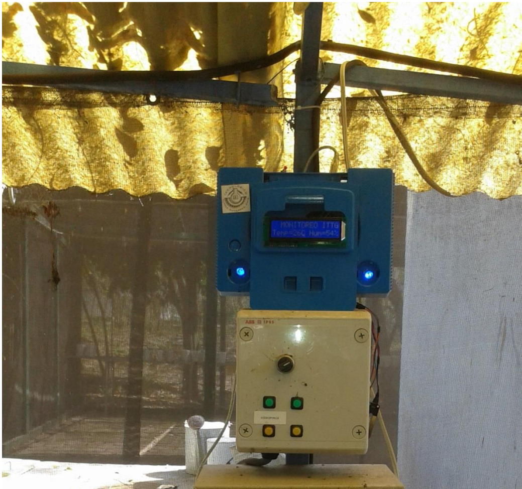
Figura 3.44 Estación meteorológica mostrando la temperatura y humedad en el aire
