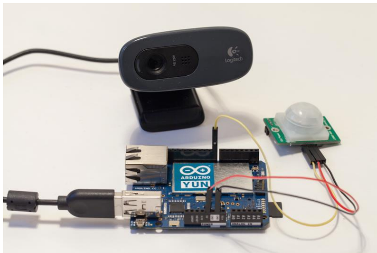
Figura 3.12 cámara y sensor de movimiento conectados al Arduino Yun
