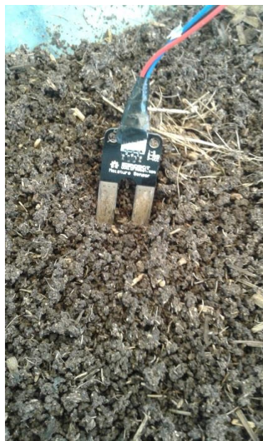
Figura 3.41 Colocación de los sensores de humedad de suelo
