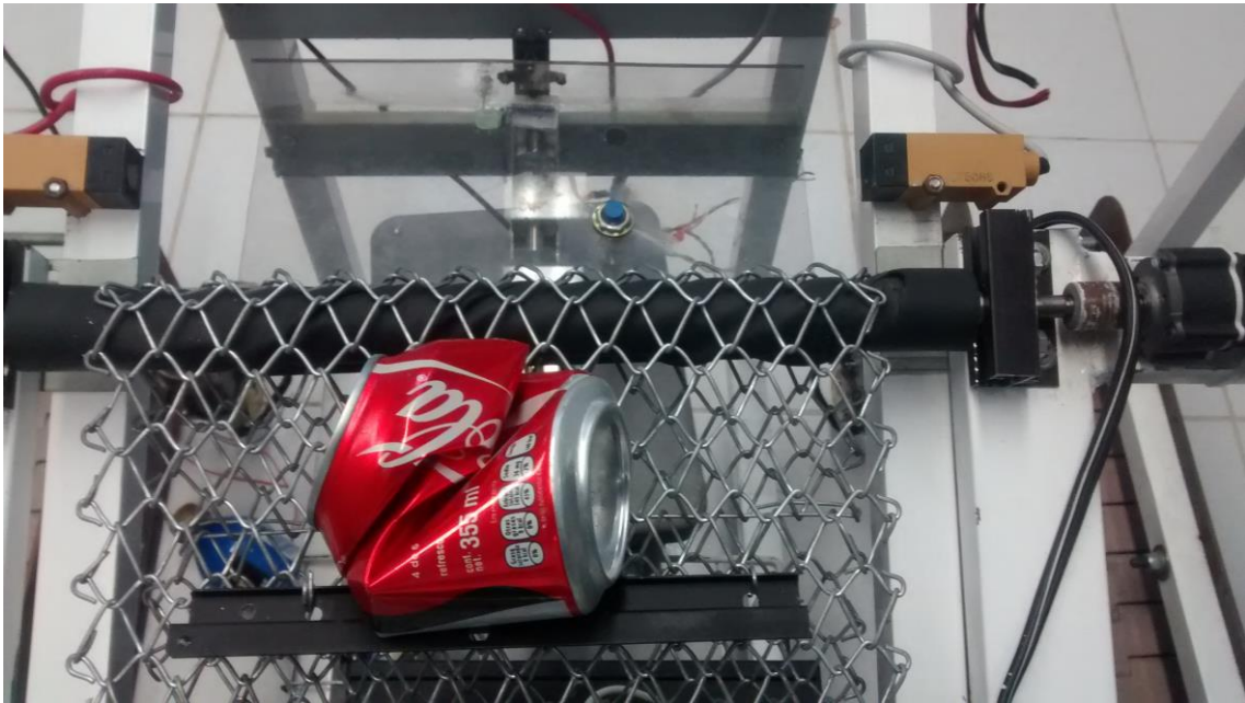
Figura 4.2 lata de aluminio suministrado y cayendo para ser detectados por los sensores reflexivos
