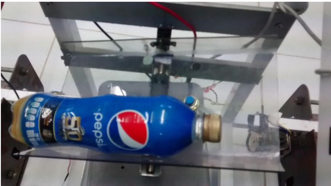
Figura 4.3 el envase de PET es separado ayudado por el servomotor que se inclina para que este en el contenedor correspondiente.
