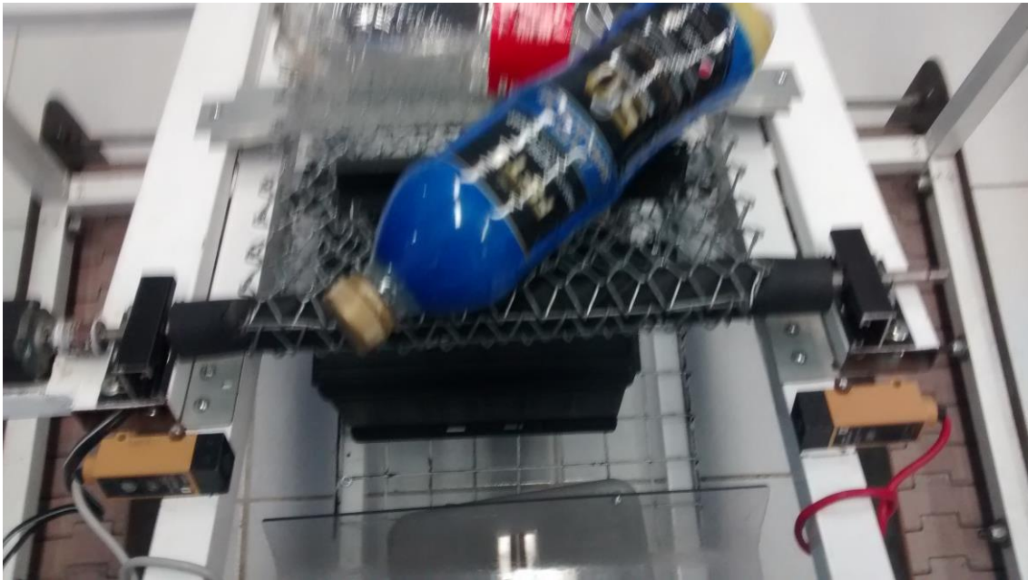
Figura 4.1 envase de PETs suministrado y cayendo para ser detectados por los sensores reflexivos
