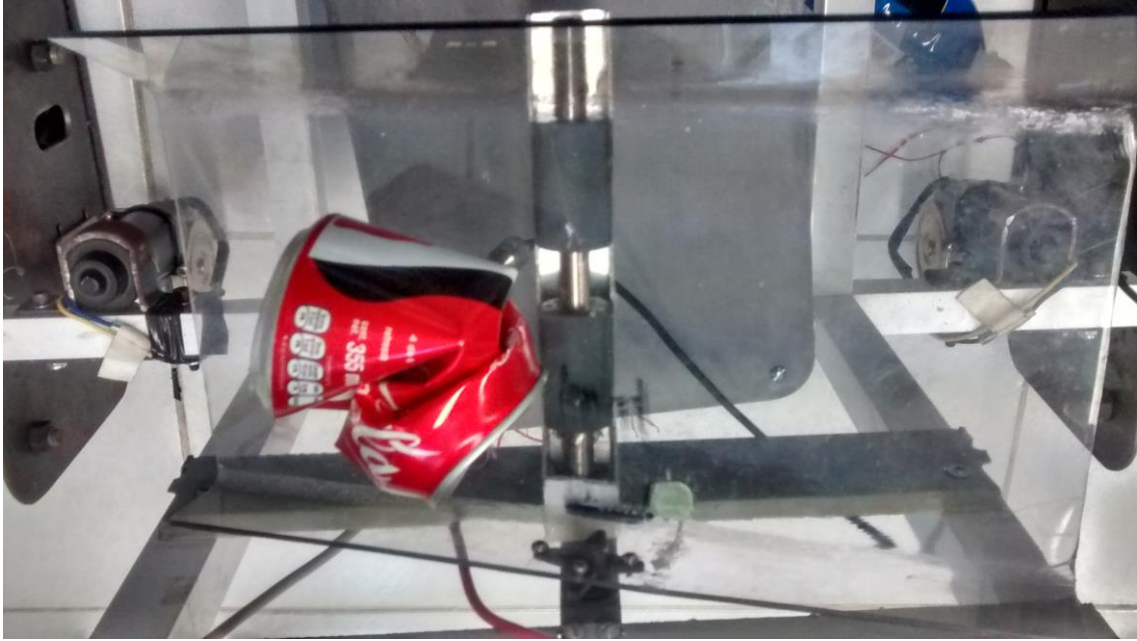
Figura 4.4 el envase de aluminio es separado ayudado por el servomotor que se inclina para que este en el contenedor correspondiente.
