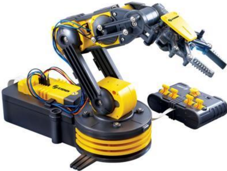
Imagen 10. Robot STEREN K-680 (Izquierda), control alámbrico que controla el movimiento hacia ambas direcciones de cada eslabón y la pinza (Derecha).
