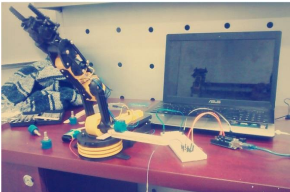
Imagen 29. Robot totalmente armado con algunos potenciómetros que posteriormente serán utilizados como sensores, Derecha: partes totalmente desarmadas.
