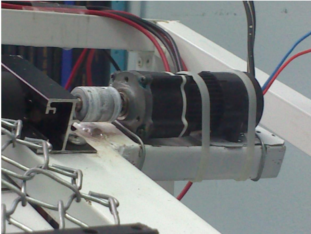
Figura 4.22 Motor sujeto al rodillo mediante cople metálico
