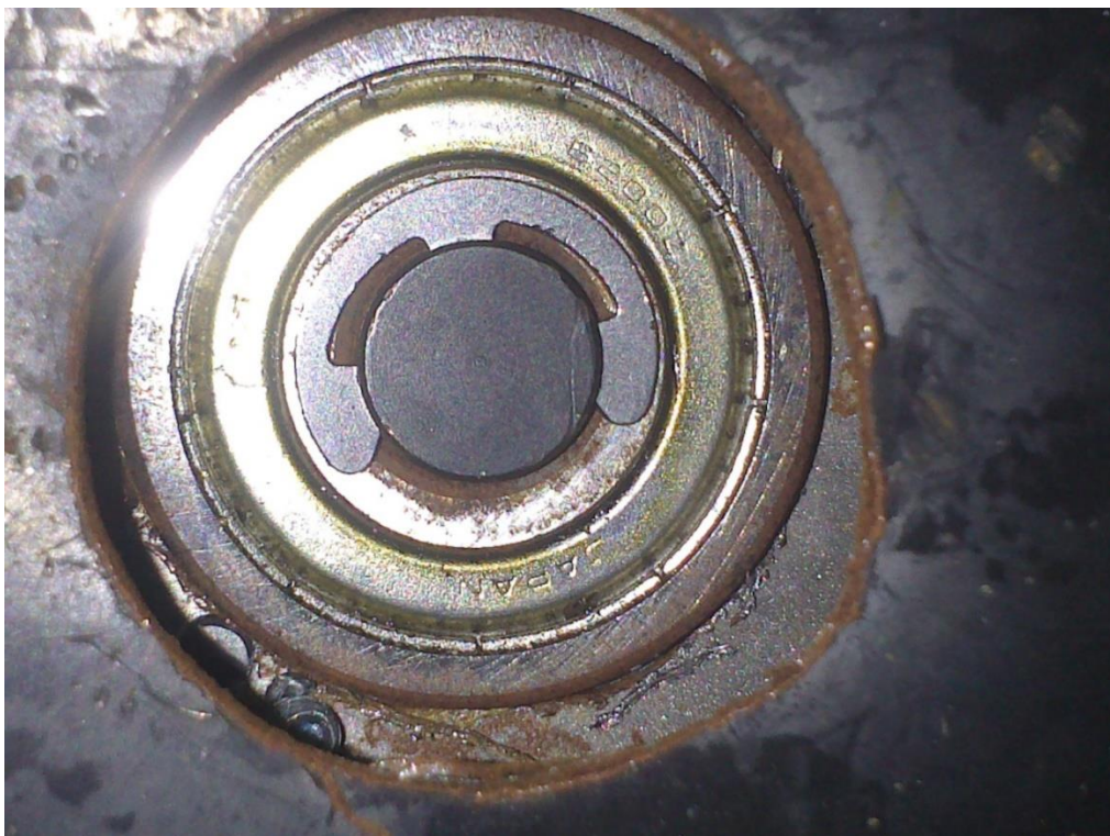
Figura 4.10 Seguros en los extremos de cada eje
