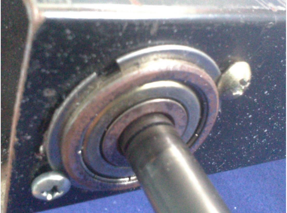
Figura 4.12 Estabilizar balero del eje de introducción
