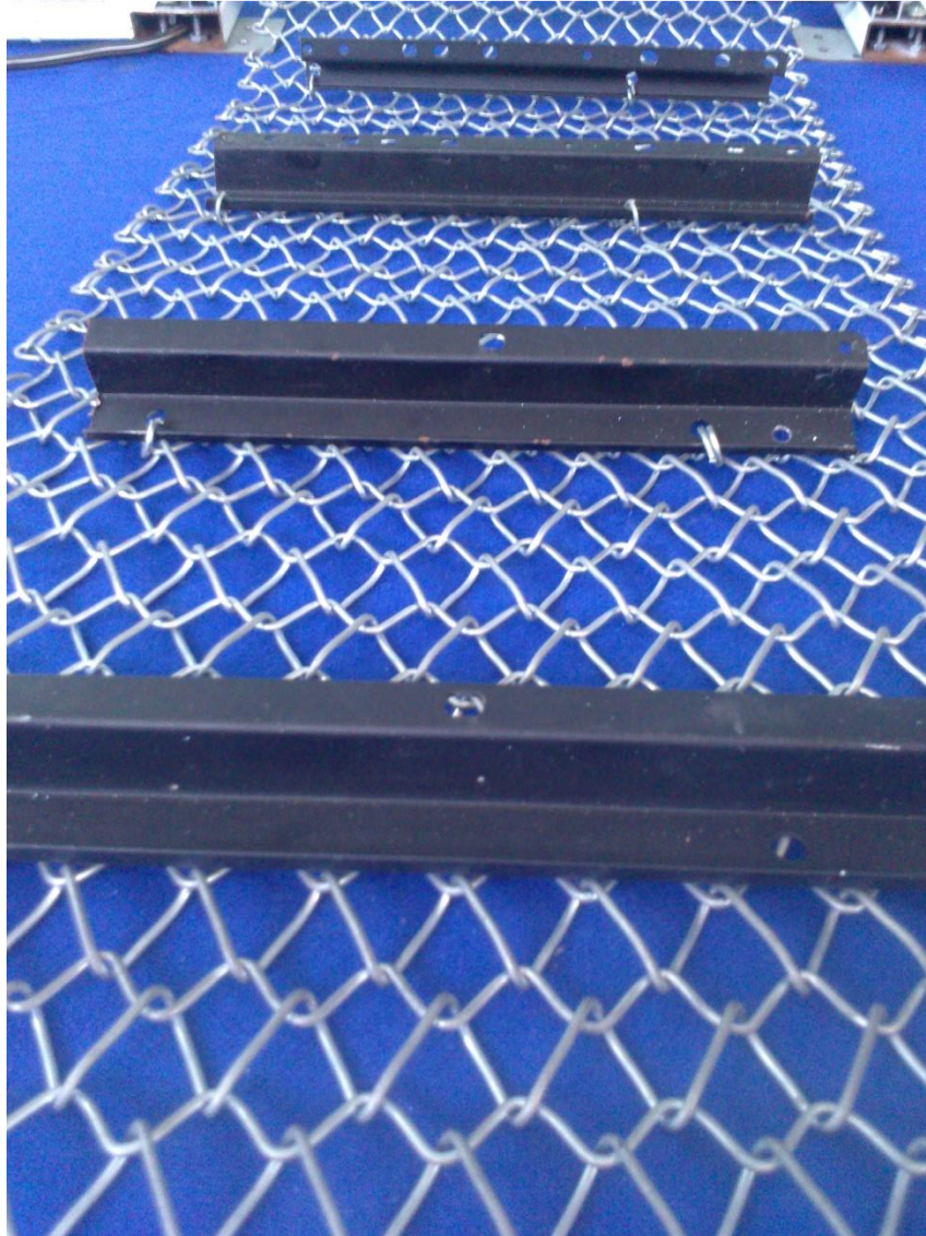
Figura 4.21 Separación entre perfiles de acero adecuada para tamaño de botella
