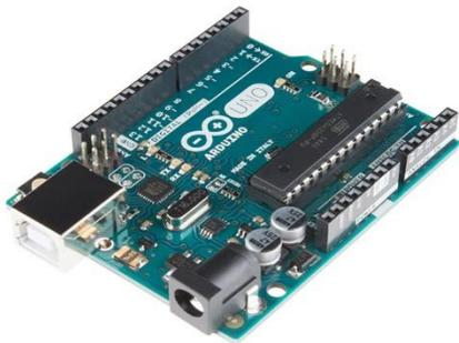
Figura 2.5 ejemplo de la tarjeta Arduino UNO
