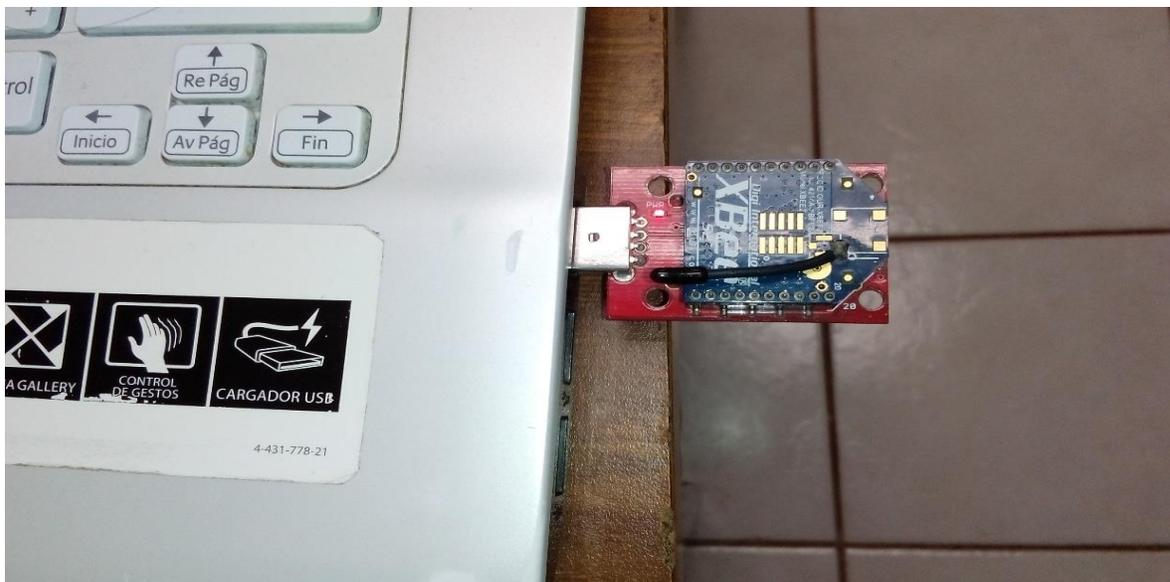
Figura 17. Conexión de XBEE s2 (TX)
