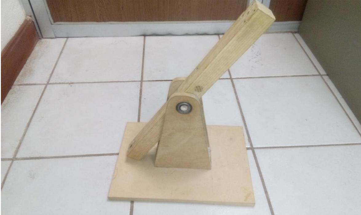
Figura 30. Construcción del PVTOL hecho de madera
