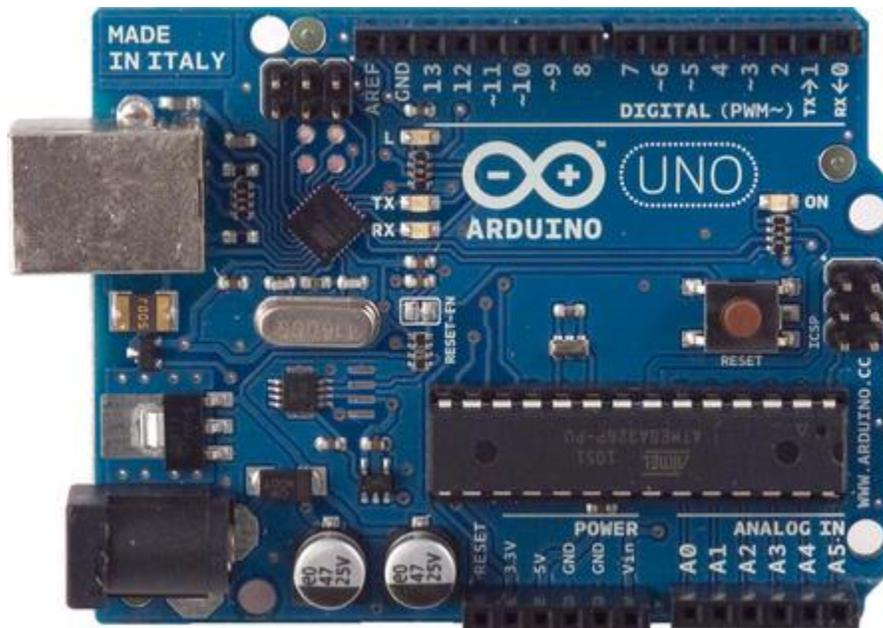
Figura 6. Placa ARDUINO UNO
