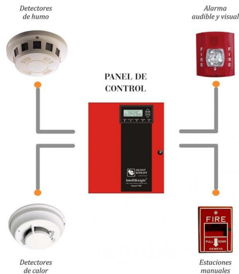
Fig. 4 Alarmas contra incendio
