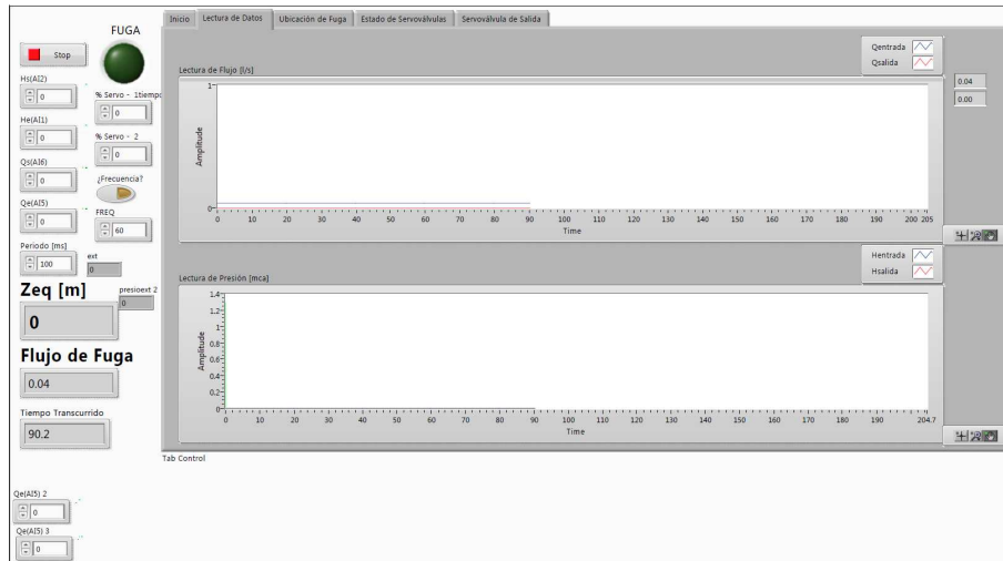
Figura 10: Pantalla del sistema SCADA
