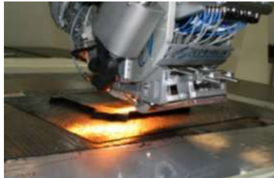
Fig. 2.5 Sistema de calentamiento por Lámparas IR de Coriolis Composites
