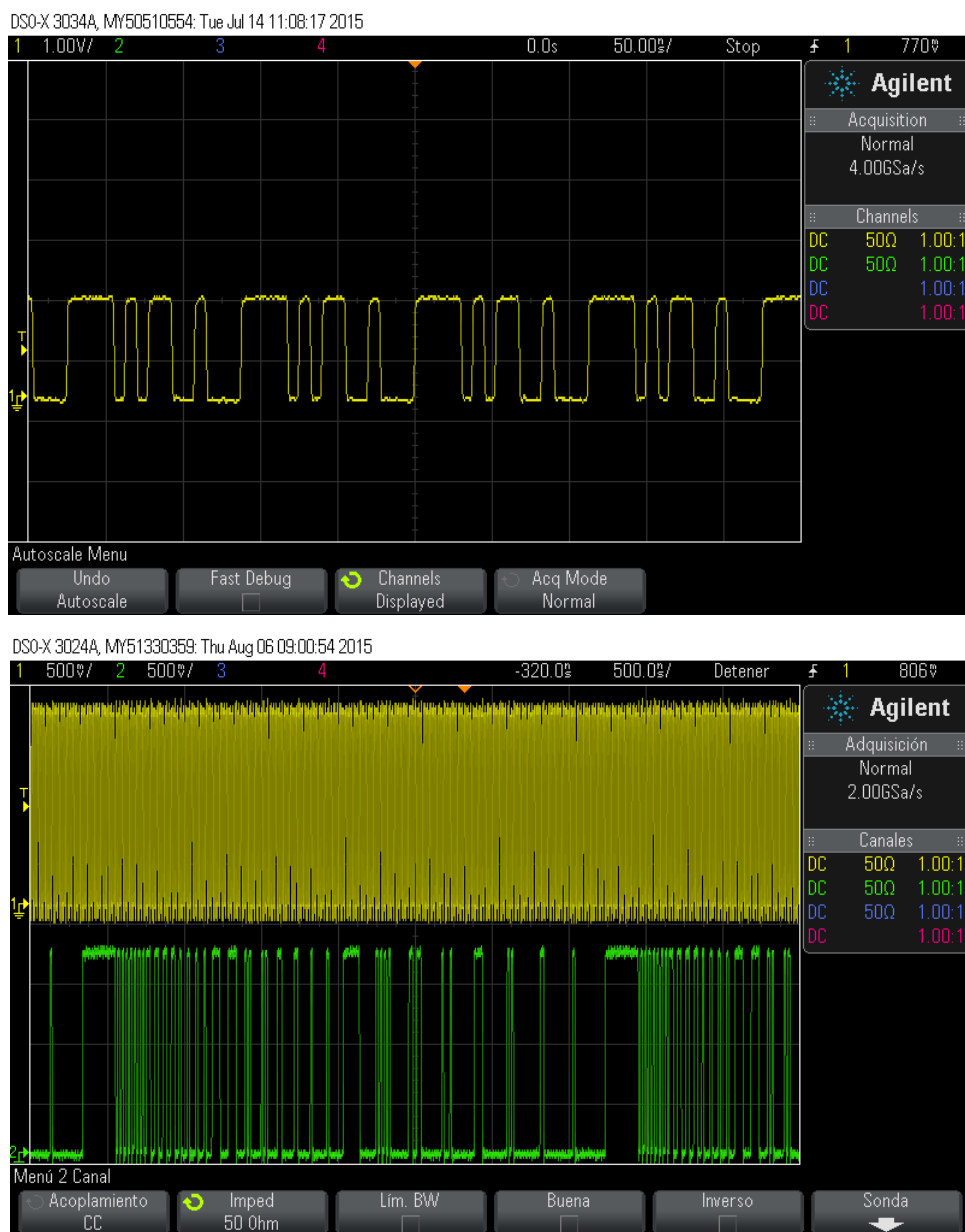
Figura 44. Datos PRBS de 4 Bits de resolución (Superior) y Datos PRBS de 8 Bits de resolución (Inferior verde).
