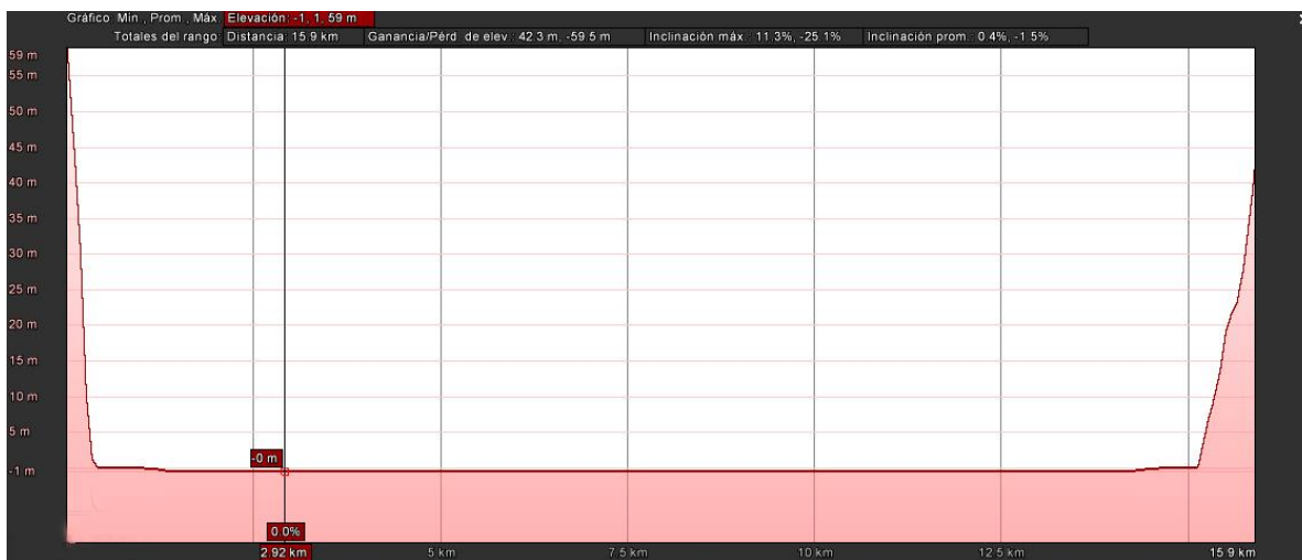
Figura 51. Perfil de elevación entre el transmisor y el receptor haciendo uso de herramientas de Google Earth.
