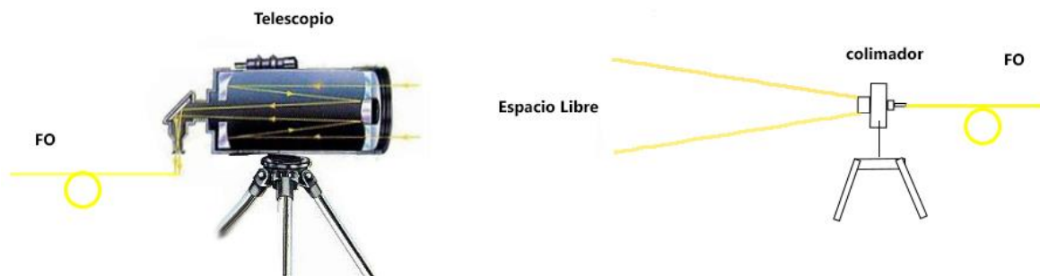
Figura 49. Esquema que ejemplifica la función del telescopio como antena receptora.
