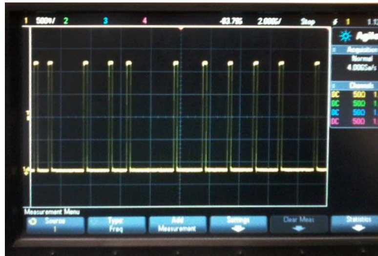
Figura 57. Resultados de la Modulación PPM.
