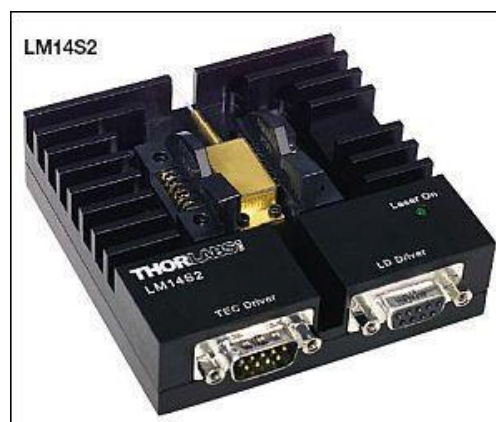
Figura 46. Inserción del diodo laser a la base LM14S2.
