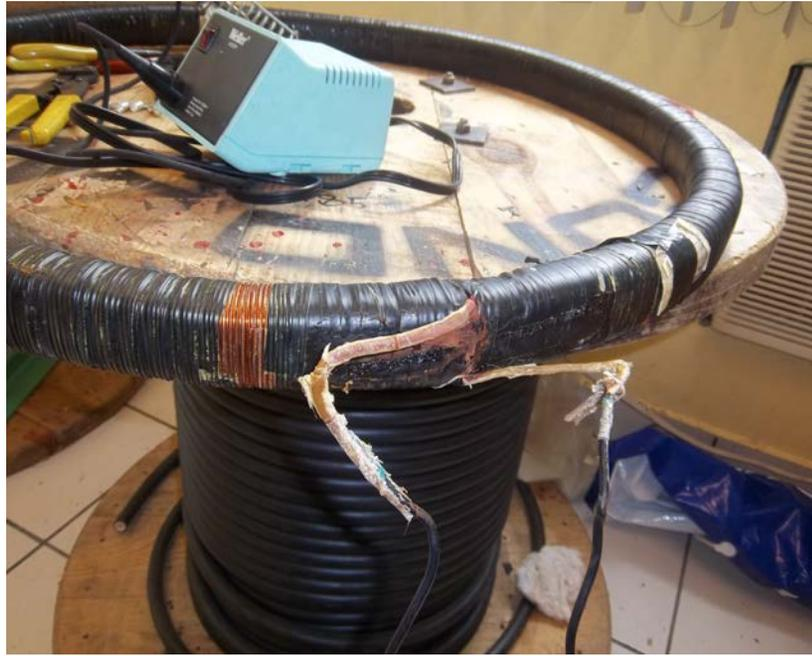
**Fig.4.2.2 aislamiento dañado**
