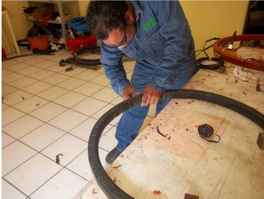
**FIG. 4.7.2 Retiro del aislante dañado**
