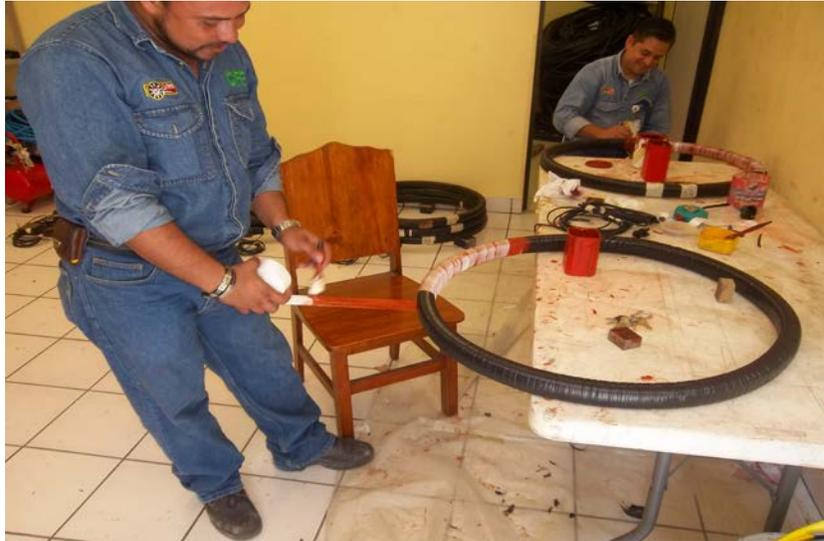
**FIG 4.7.5 colocación de la cinta de fibra aislante**
