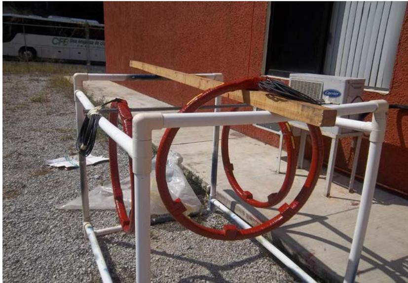
**FIG. 4.7.6 Secado del barniz transparente de las de los TC'S**
