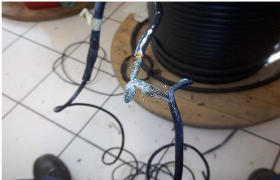
**Fig.4.2.3 circuitería de los TC'S dañados**
