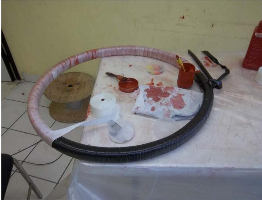
**FIG.4.3.2 Aislación con fibra de vidrio**
