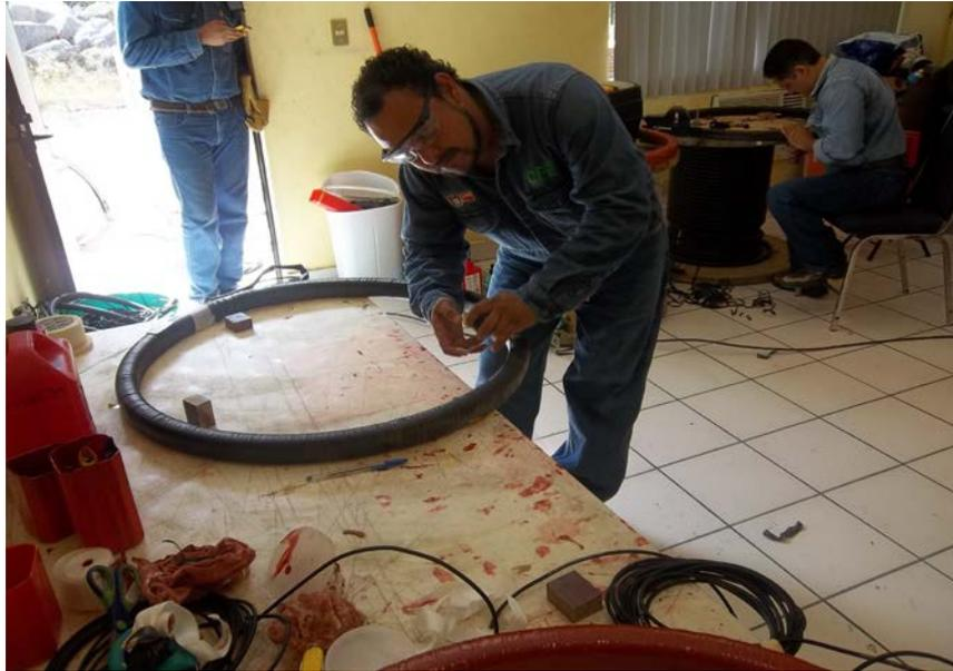
**FIG.4.7.3 Colocación de la nueva cinta aislante**
