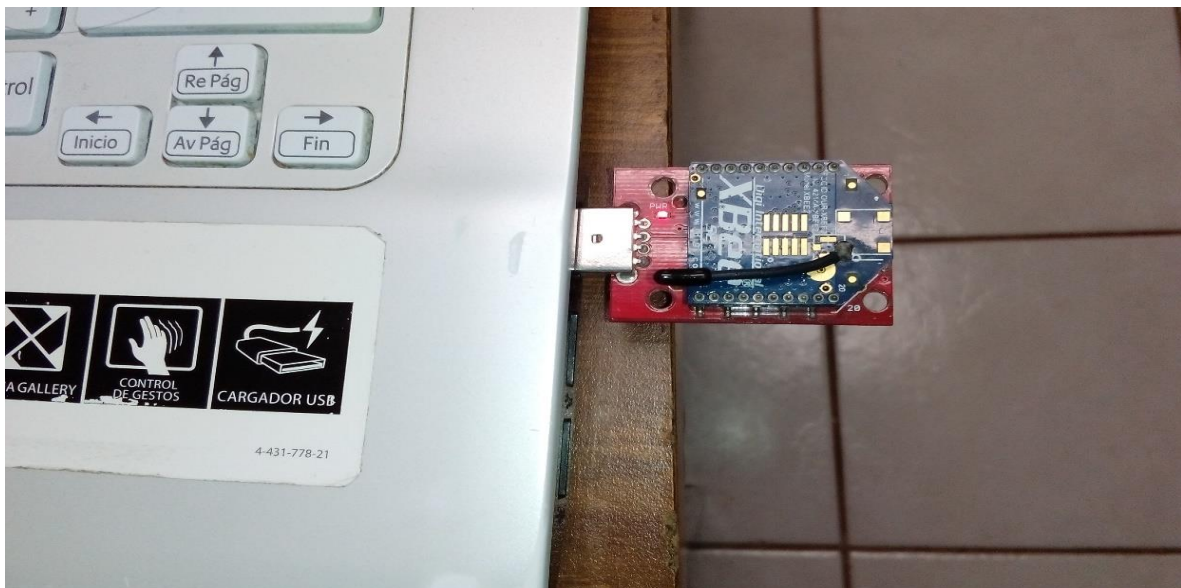
Figura 17. Conexión de XBEE s2 (TX)
