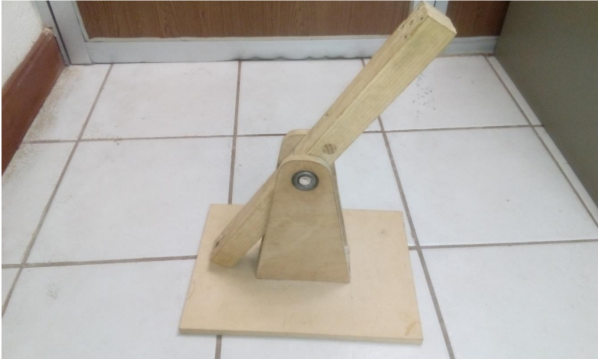
Figura 30. Construcción del PVTOL hecho de madera
