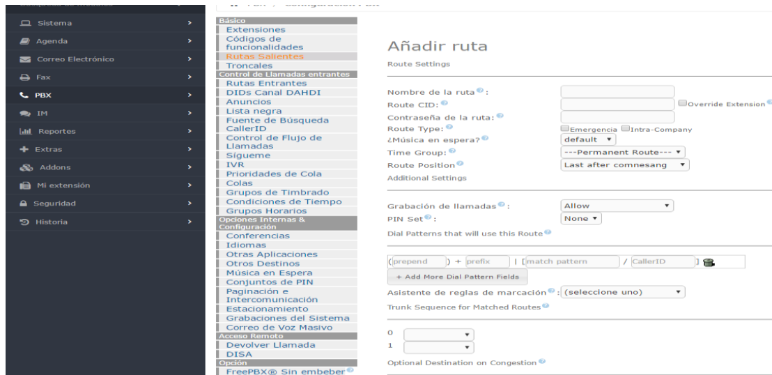
Img. 5.4.1. Paso 1 Añadir ruta de salida.
