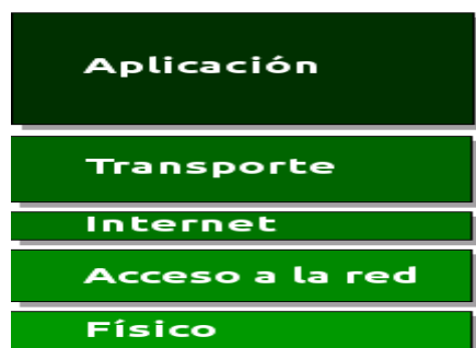
Img.3.13.1. Arquitectura TCP/IP.
