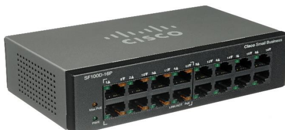
Img.4.1B Switch Cisco.
