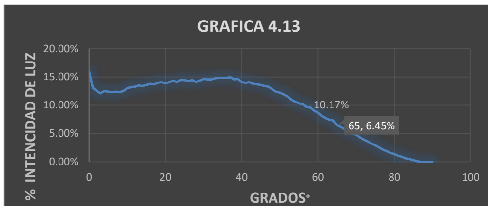
Figura 4.36. En la gráfica se puede ver como la intensidad de luz hace muchos cambios durante el movimiento angular como en la figura 4.29.
