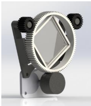
Figura.2.17. Ensamble de sujeción del polarizador y juego de engranajes.
