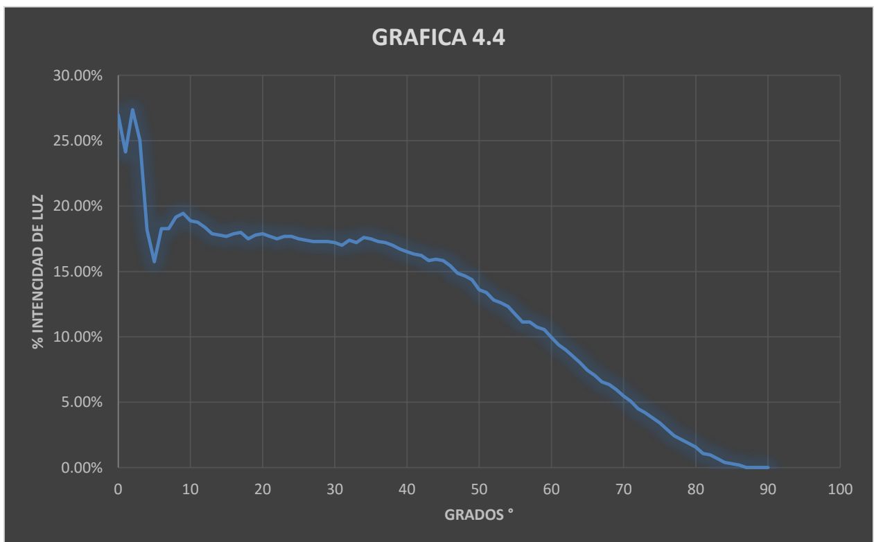
Figura 4.28. En esta grafica se ve un gran cambio de intensidad de luz a partir de 0^\circ a 10^\circ se ve como incremento y decremento jugando la intensidad de luz y a partir de 11^\circ comienzo a decremantar hasta polarizar en 90^\circ .
