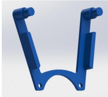
Figura.2.16. Herradura sostenible. Que hace la función de un diseño para incorporar el juego de engranajes sosteniendo al polarizador.
