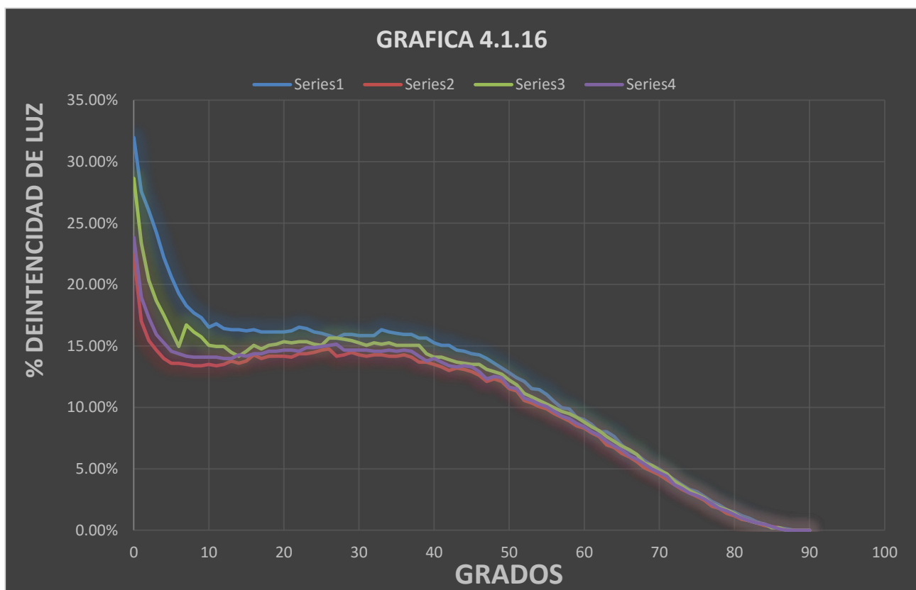
Figura.4.39. En esta grafica la intensidad de luz son similares como en el caso anterior, es decir en la serie 1,2,y 4, no hay mucha perdida es decir que se mantiene de forma estable a comparación de la serie 3 por que en la serie 3 se ve que ha perdidas de intensidad de luz, durante el movimiento angular.
