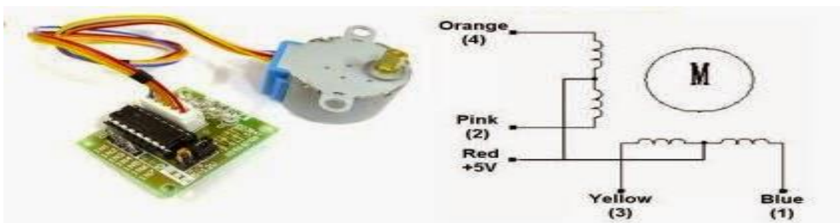
Figura. 2.7. Conexiones del motor y driver
