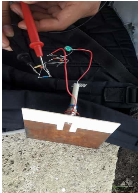
Figura 4.1) Prueba del sistema a 200 metros de una antena radiante
