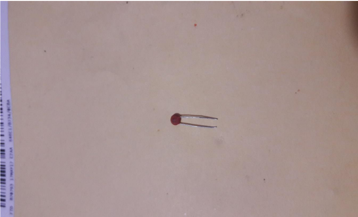
Figura 3.38) Capacitor de 69 pF
