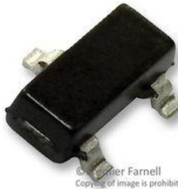
Figura 2.21) Diodo Schottky HSMS-2850
