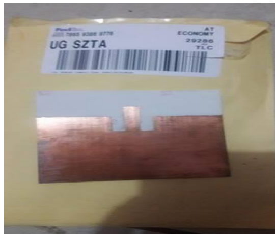
Figura 3.31) Antena microstrip resultante
