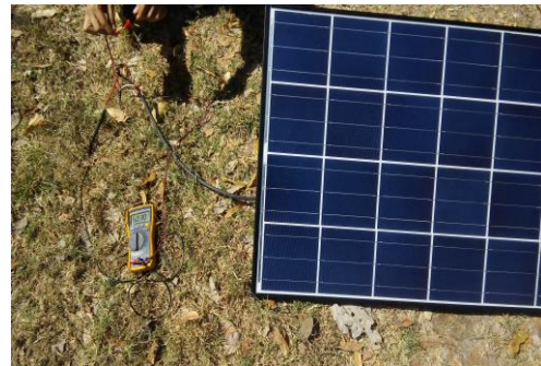
Figura 5.6 Medición de la corriente en corto circuito del panel = 6.030A
