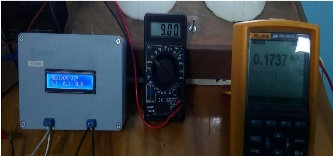
Figura 5.43 Ilustración de las mediciones de voltaje, corriente y potencia con respecto a la interfaz.
