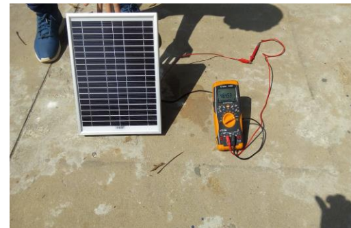
Figura 5.4 Medición de la corriente en corto circuito del panel = 464.53mA
