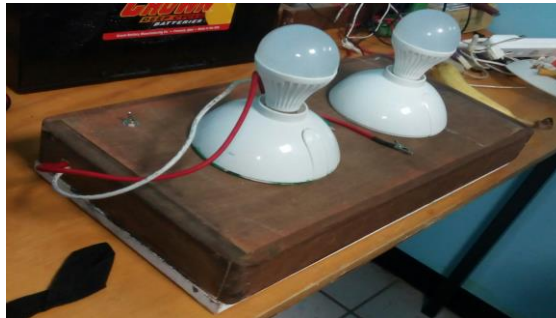
Figura 5.24 Ilustración del tablero de cargas.
