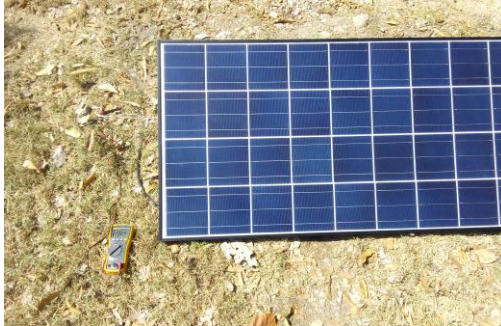
Figura 5.5 Medición d voltaje en circuito abierto del panel = 20.6Avdc.
