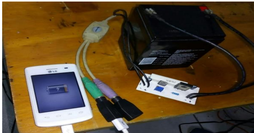
Figura 5.30 Ilustración del convertidor DC-DC 12v a 5v prueba con carga de celular.
