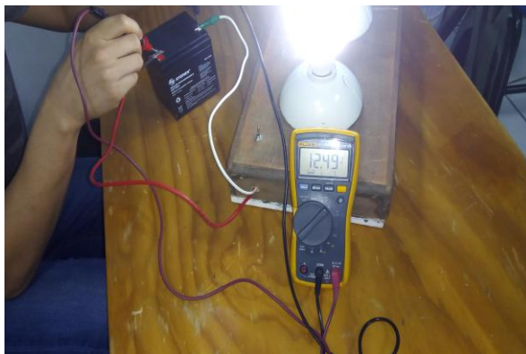
Figura 5.17 voltaje medido: 12.49VDC.
