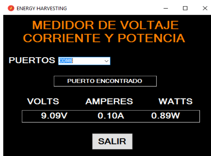
Figura 5.42 Ilustración de la Interfaz del medidor de voltaje, corriente y potencia en funcionamiento
