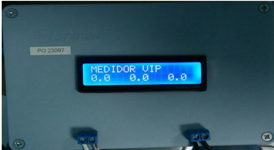
Figura 5.37 Ilustración del medidor de voltaje, corriente y potencia.
