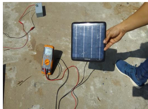
Figura 5.2 Medición de la corriente en corto circuito del panel = 158.55mA
