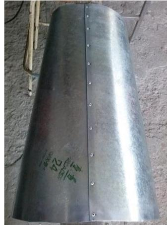
*Fotografía 3.1 Tronco de cono de lámina galvanizada.*
