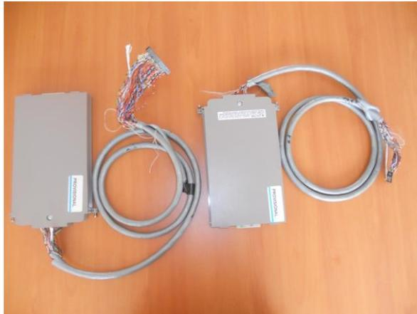
Fotografía 3.5 Tarjeta de adquisición de datos KEITHLEY 7706 y 7708
