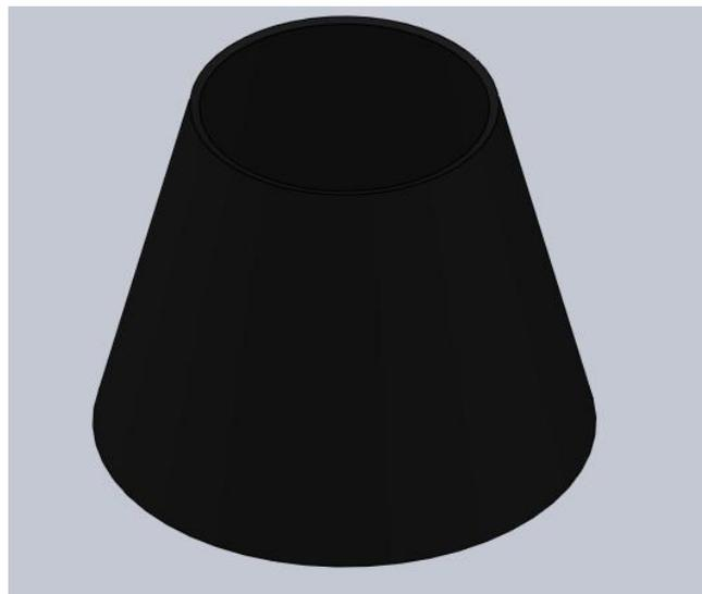
Figura 2.2.2 Placa absorbedora cilindro cónico simple.
