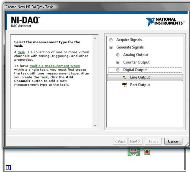
Figura 3.10: Asistente de la DAQ configurado digitalmente como salida
