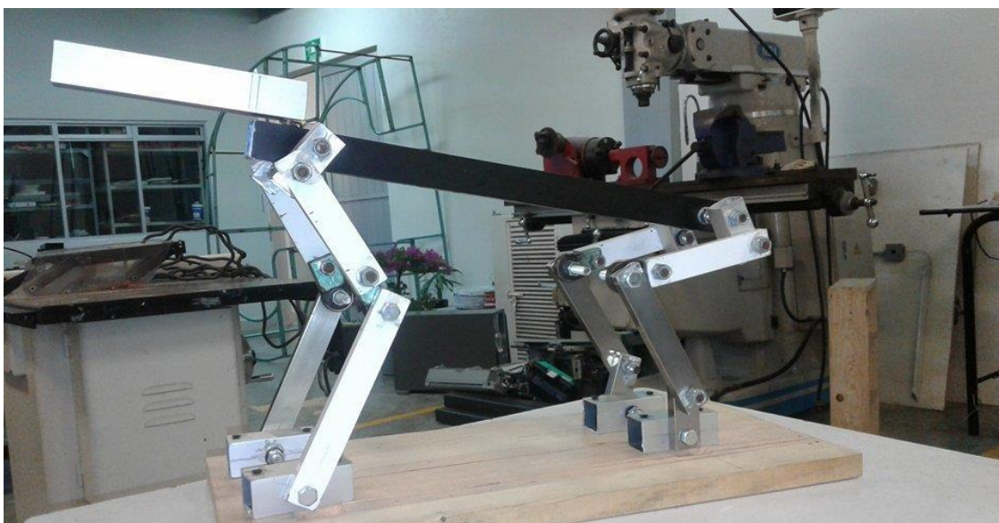
Figura 4.7. Exoesqueleto completamente terminado, anclado a suelo y con todas sus articulaciones funcionales.
