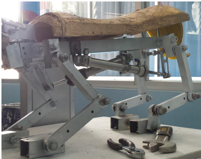
Figura 4.8. Vista lateral del exoesqueleto con los pistones integrados.
