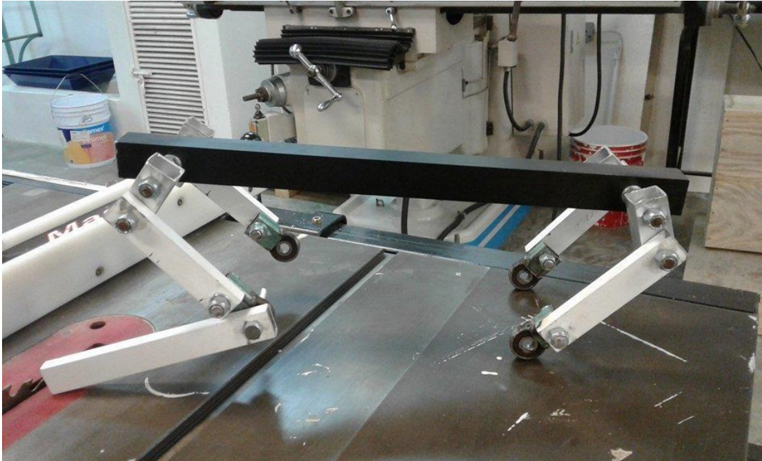
Figura 4.4. Exoesqueleto con 4 baleros soldados, los cuales funge como codos y rodillas.
