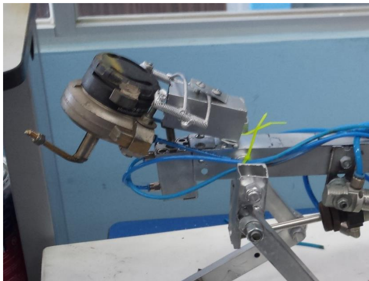
Figura 4.9. Vista lateral del exoesqueleto con los pistones integrados.
