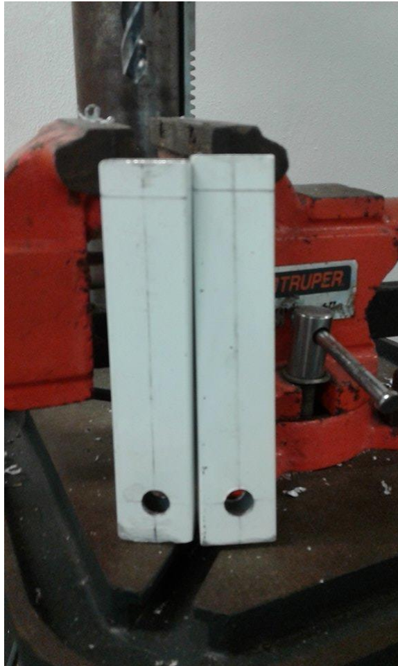
Figura 4.3. Fémures realizados con 2 piezas de aluminio cuadrado.
