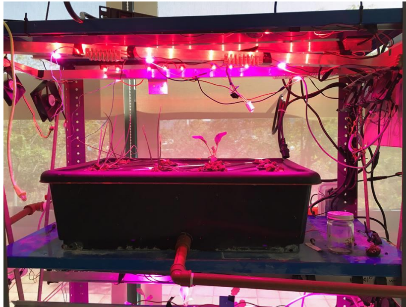
Ilustración 5.9. Ensamble de las barras al sistema de iluminación del invernadero. Fuente: Propia
