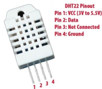
Ilustración 3.8. Sensor de temperatura y humedad DTH22. Fuente: www.adafruit.com
