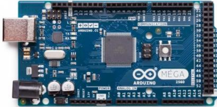
Ilustración 3.5. Placa Arduino Mega 2560. Fuente: www.arduino.cc
