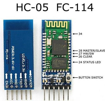
Ilustración 3.6. Módulo bluetooth HC-05. Fuente: www.arduino-elektronika.eu
