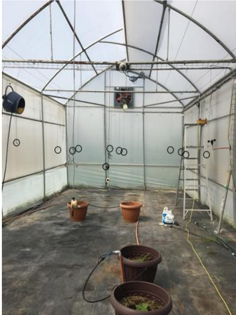
Ilustración 4.6. Conexión de los 12 sensores DTH22. Fuente: Propia
