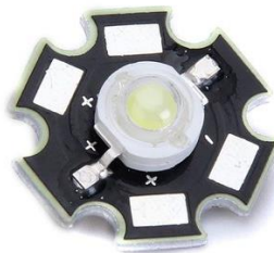
Ilustración 3.9. LED de alta potencia 3W. Fuente: Propia
