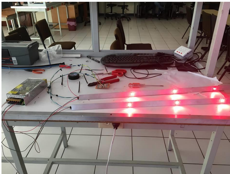
Ilustración 5.8. Construcción de las barras de LED. Fuente: Propia.
