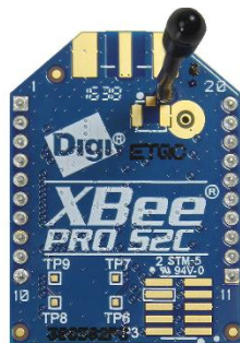
Ilustración 3.7. Módulo Xbee S2C con antena receptora. Fuente: www.parallax.com
