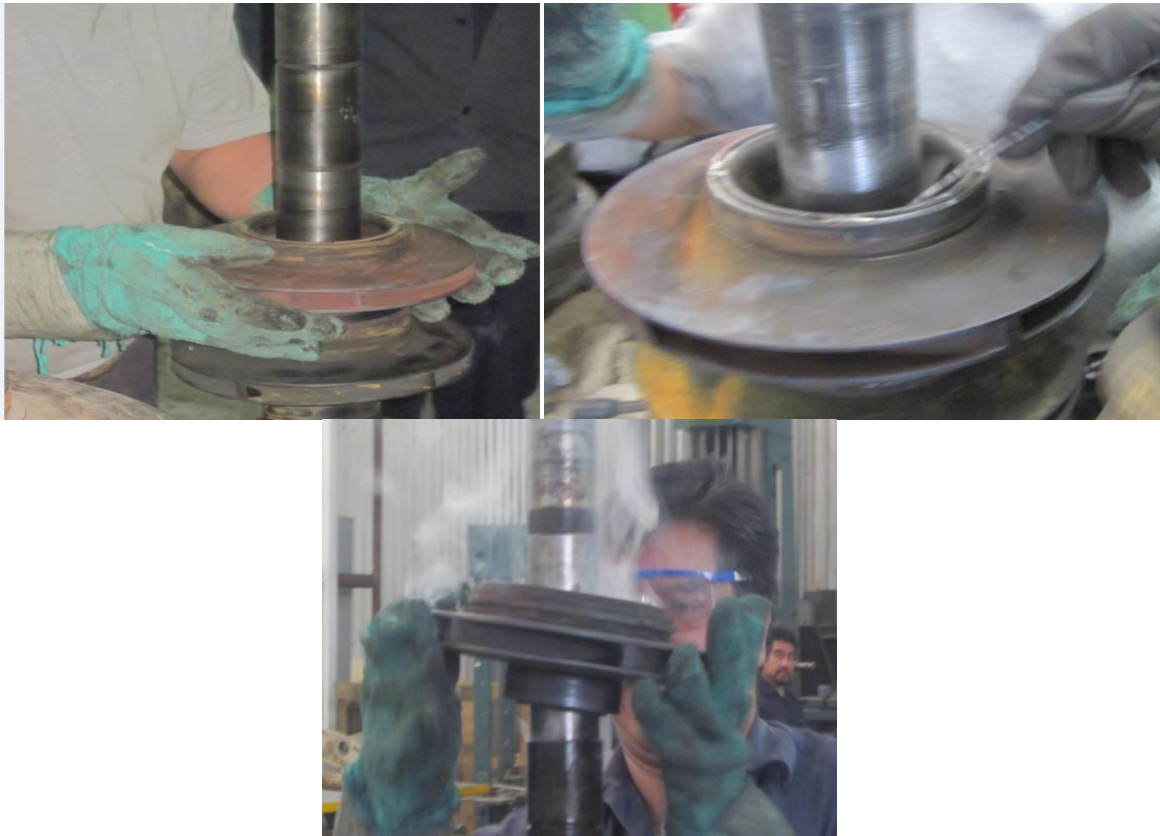
Fig.66 Extracción de cuñas, candados e impulsor
