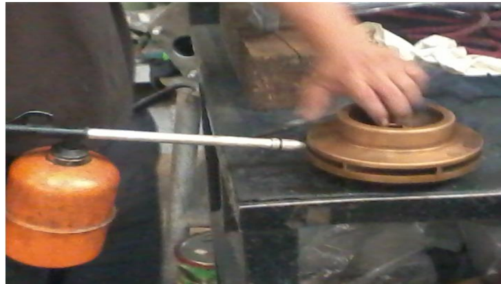
Fig.112 Limpieza pulverización baja presión
