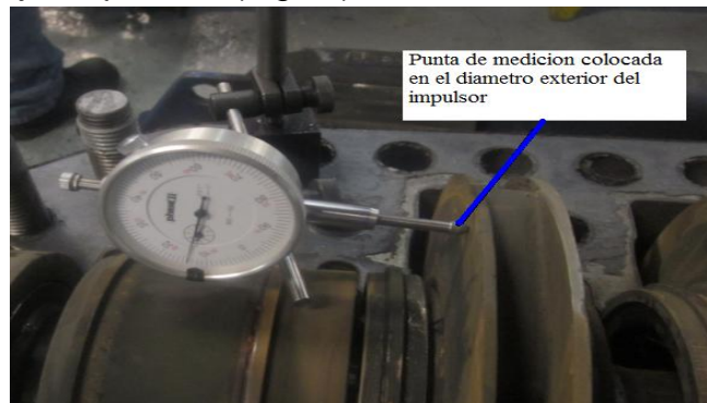
Fig.42 Posición correcta del comparador
