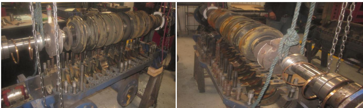
Fig.50 Desmontaje del rotor
