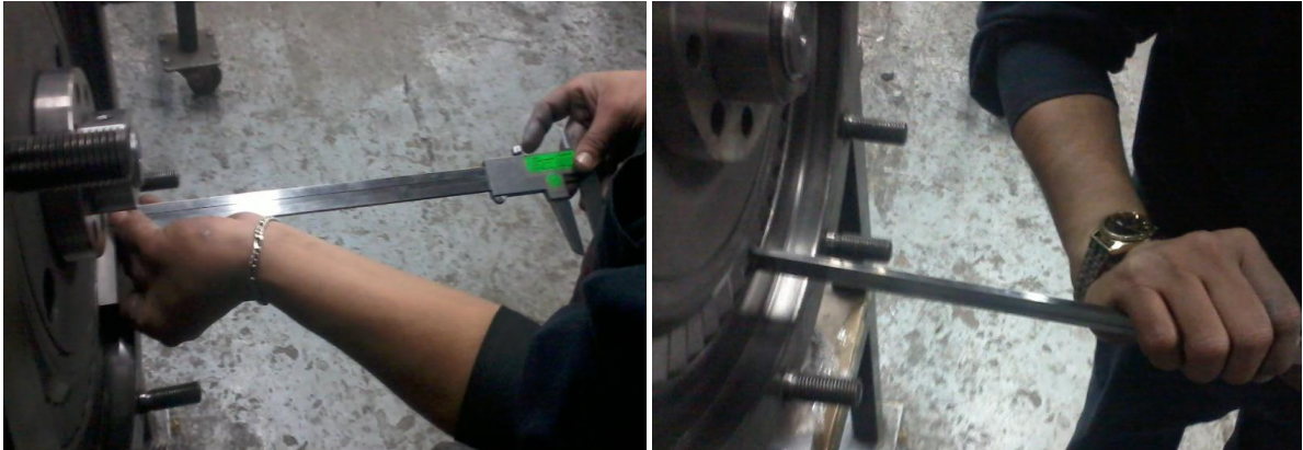
Fig. 124 ajuste de rodete-tobera y alabes-carcasa
