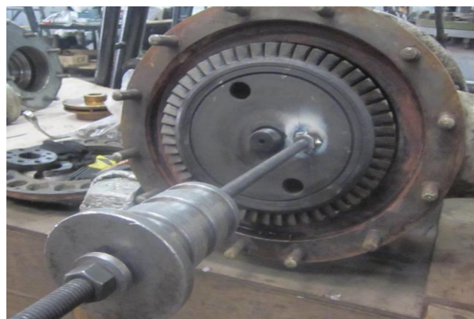
Fig.106 Extracción de alabes
