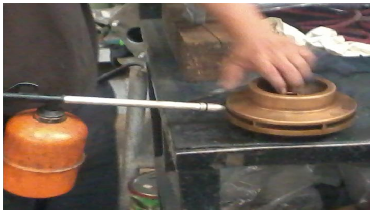
Fig.74 Limpieza pulverización baja presión
