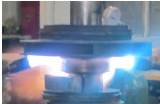
Fig.65 Aplicación de calor a impulsor
