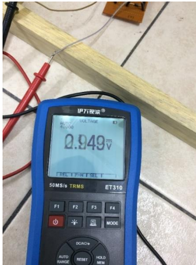
Figura 32: 4.2.1 Medición de voltajes en la salida del rectificador Fuente: Elaboración propia
