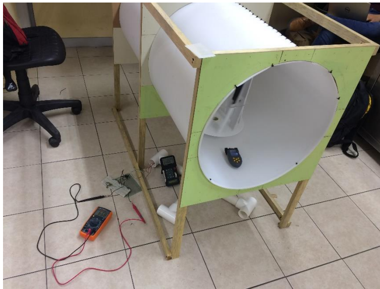
Figura 42: Medición de voltaje y corriente del generador Fuente: Elaboración propia
