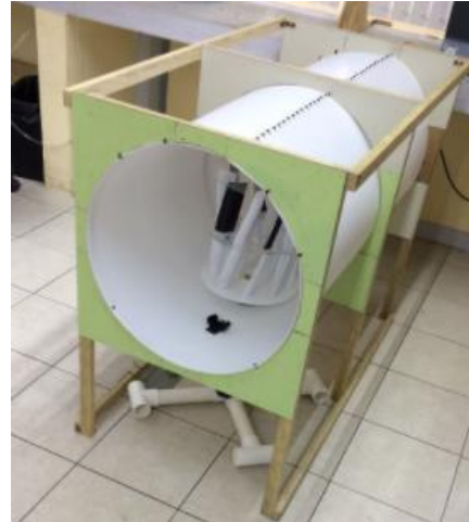
Figura 25: 4.1.5 Construcción y ensamble de túnel de pruebas Fuente: Elaboración propia
