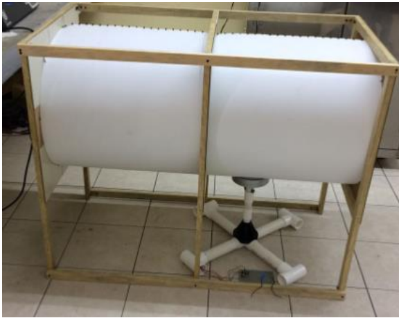
Figura 25: 4.1.5 Construcción y ensamble de túnel de pruebas Fuente: Elaboración propia
