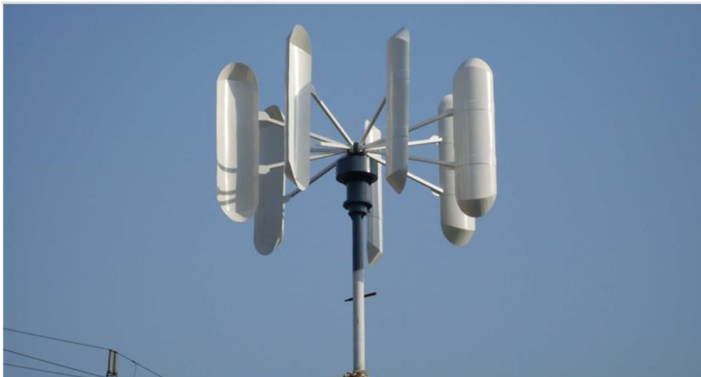
Figura 5: 3.1.1 Aerogenerador de eje vertical tipo Savonius ; Fuente: https://www.renovablesverdes.com/aerogeneradores-verticales/
