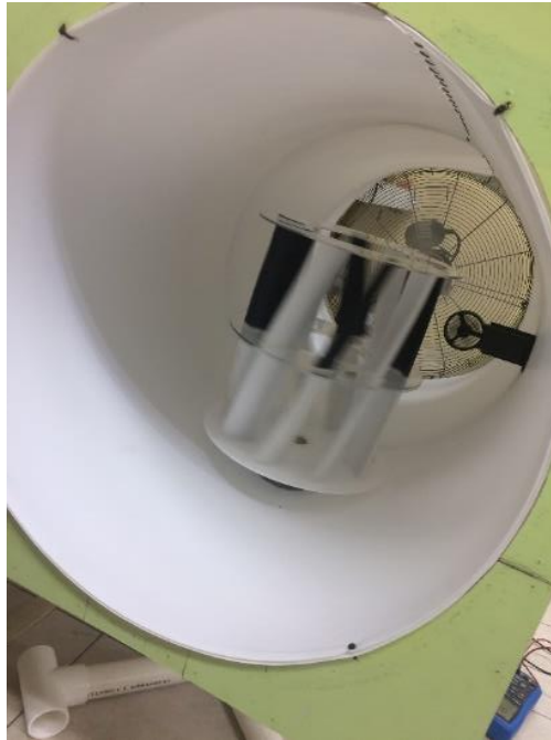
Figura 39: 4.2.4 Se coloca segundo nivel de alabas para medición Fuente: Elaboración Propia.
