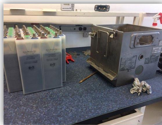
Fig. 3.11 Desarmado de una pila de Níquel-Cadmio de un avión de la familia A320 (mismo modelo para A319, A320, A321, A330).
