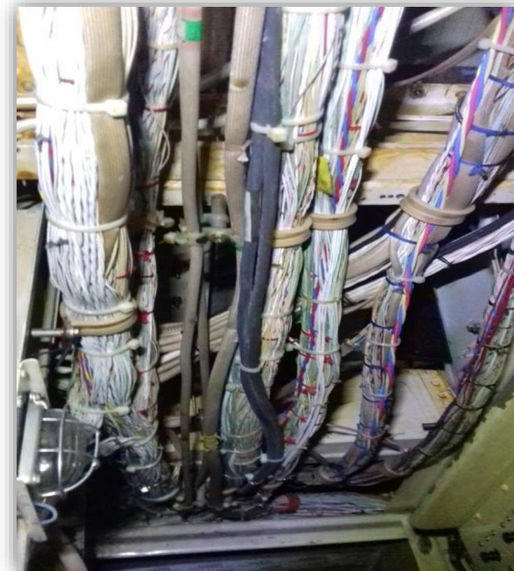
Fig.3.3 Cableado del compartimento avionics por encima del RAC1.
