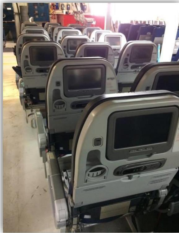
Fig. 3.16 Remoción de asientos para limpieza de EWIS del IFE, posterior a la prueba.
