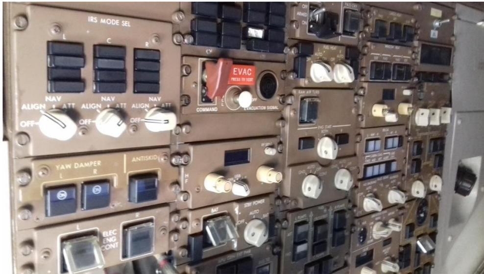
Fig. 3.6 Panel de EEC (Electric Engine Control) y ASCS (AntiSky Control Sistem).
