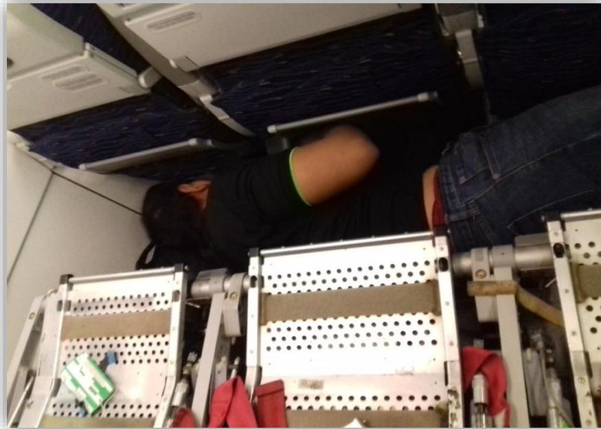
Fig. 3.18 Colocación de cables del IFE por debajo del cover.
