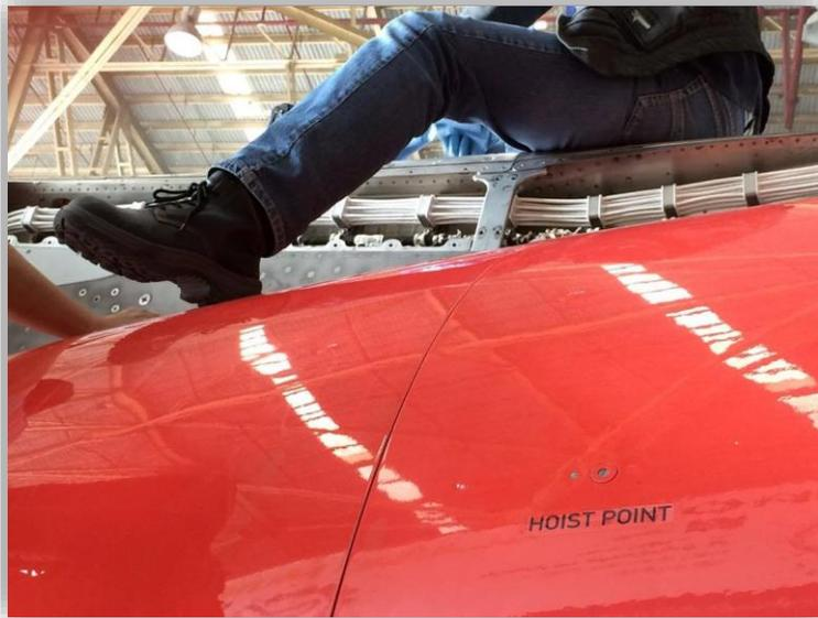
Fig. 3.23 EWIS en la parte superior de los motores
