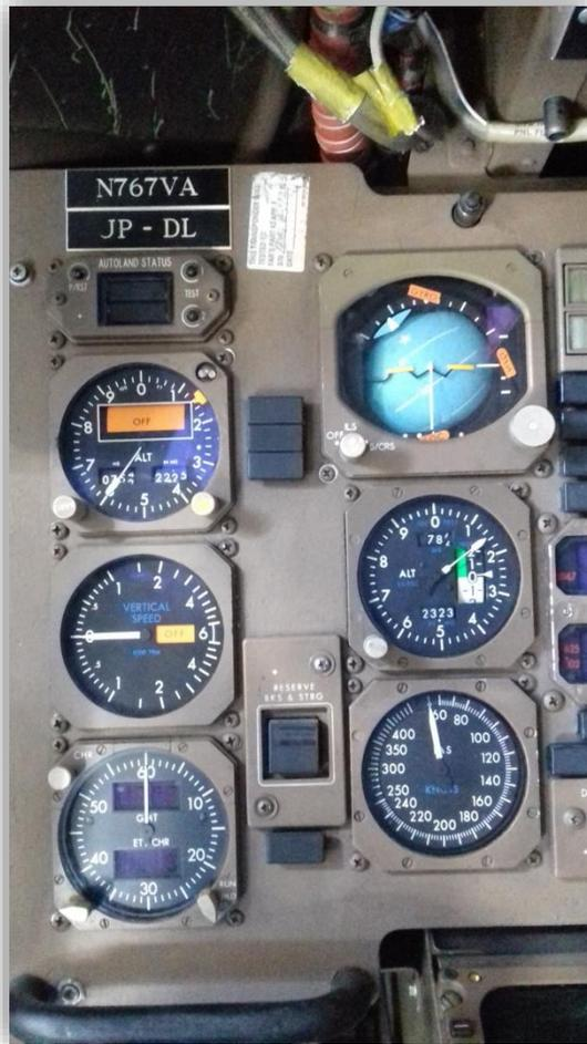
Fig. 3.7 Controles de vuelo analógicos. Horizonte, Altimetro, Velocímetro, VOR.
