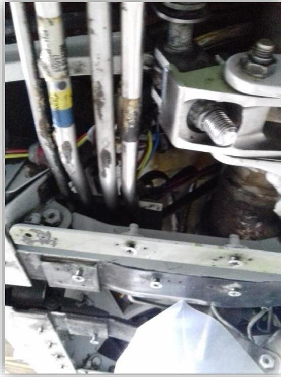
Fig. 3.19 EWIS en la semi-ala derecha del borde de ataque de un A320.
