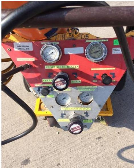
Fig. 3.24 Equipo para prueba de tubos de pitots
