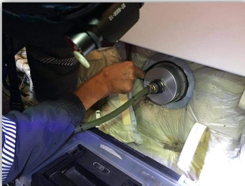
Fig. 3.22 mantenimiento de los lectores de altimetría
