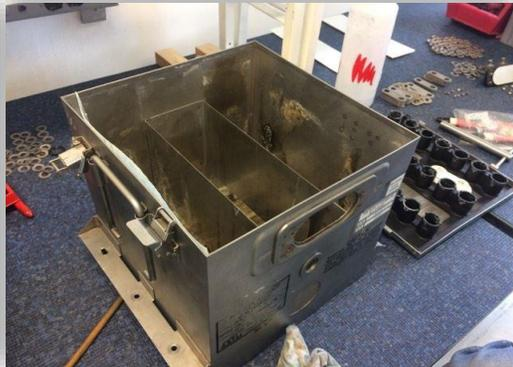
Fig. 3.9 Batería desarmada, quedando únicamente carcasa.
