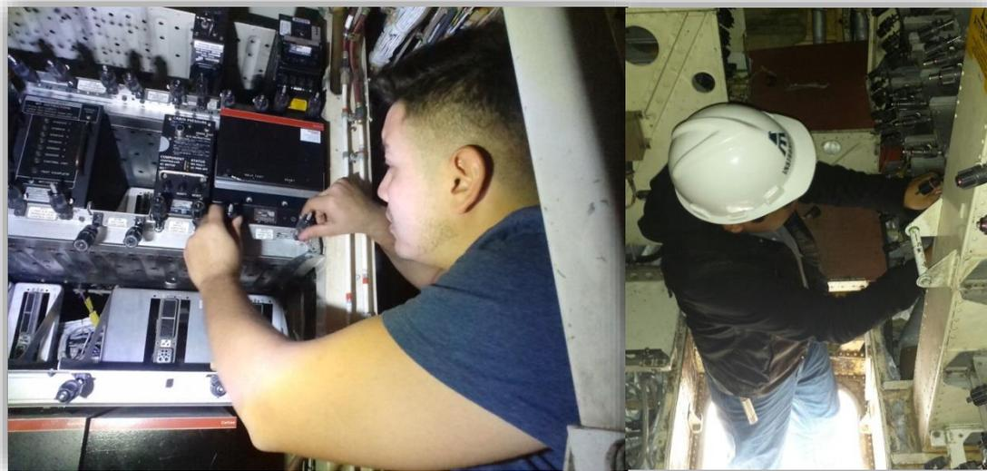
Fig. 3.1 Remoción de computadores del compartimento Eléctrico y Electrónico.
