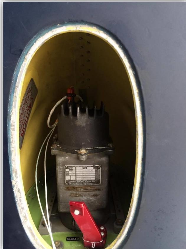
Fig. 3.21 Bomba de combustible con cable de tierra ya conectado.
