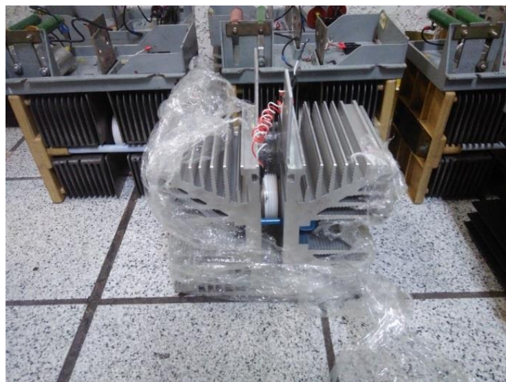
Figura 3.11. Remplazo del tiristor 1.
