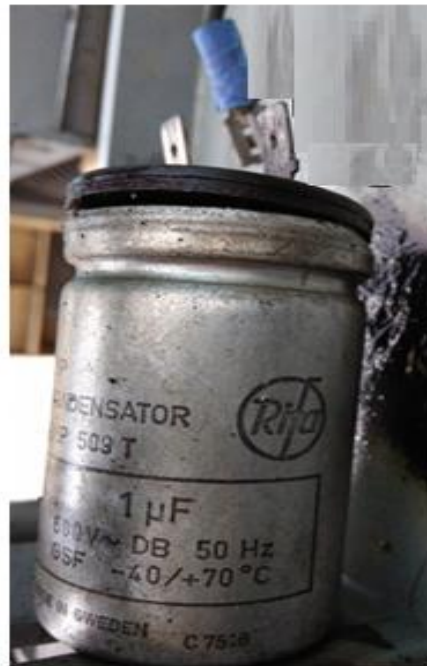
Figura 3.12 Capacitor fuera de servicio.
