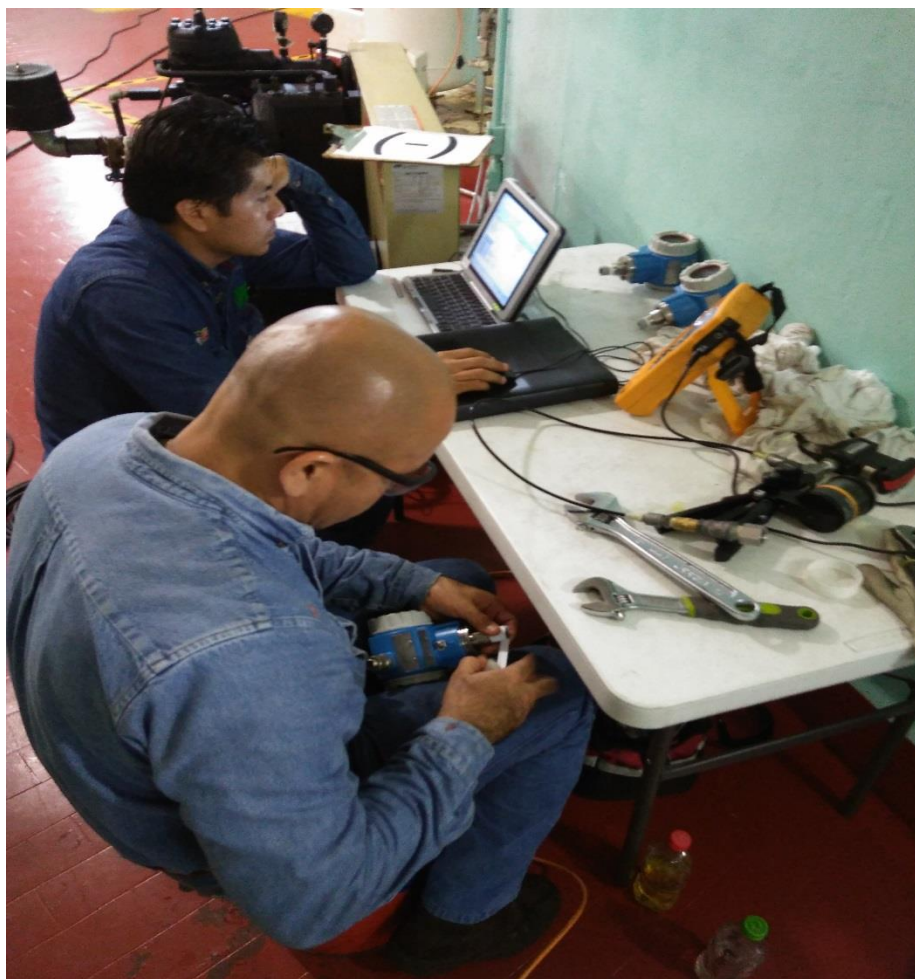
Figura 3.31. Mantenimiento y calibración de instrumentos PA de presión.
