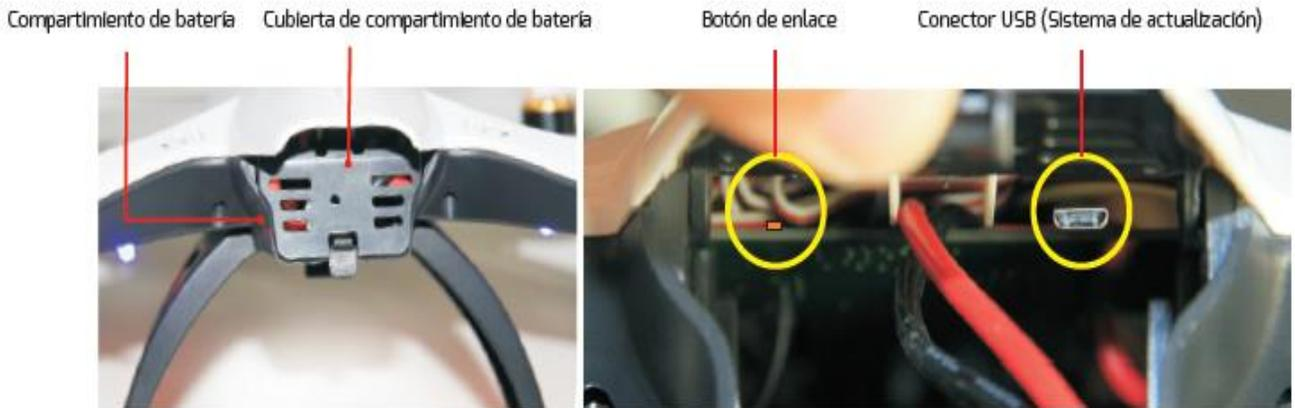
Figura 3.2: Conexión del puerto USB
