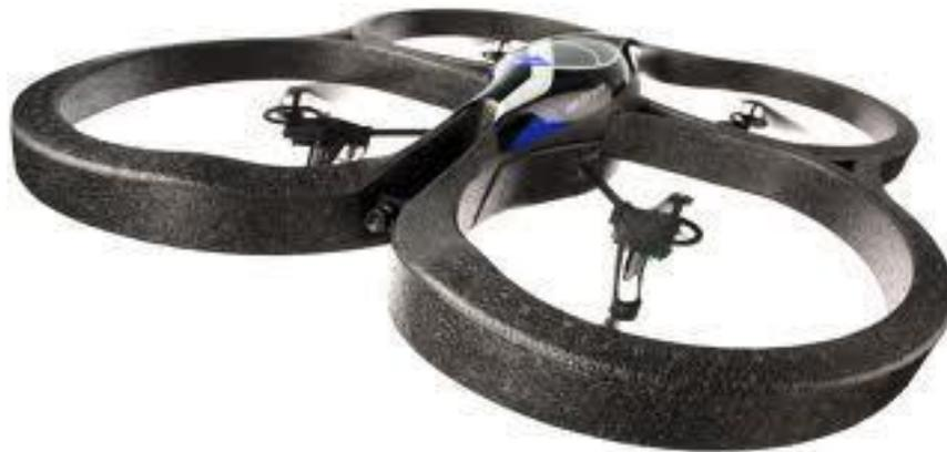
**Figura 1.1:** AR Drone Dispone dos microcámaras incorporados que permiten grabar video.
