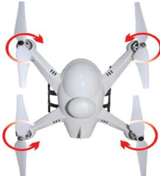
**Figura 3.6.2:** Dirección del Giro de las posiciones de las propelas
