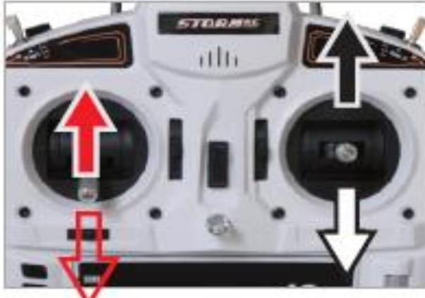
**Figura 3.5.1:** La palanca de mando izquierda arriba-abajo; control vertical de la aeronave derecha-izquierda; dirección de la aeronave a nivel horizontal.
