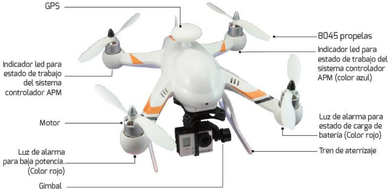
**Figura 3.1:** Indicaciones de instalación de cada dispositivo del Drone
