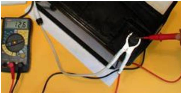
**Fig. 3.7.-** Voltaje de la Batería
