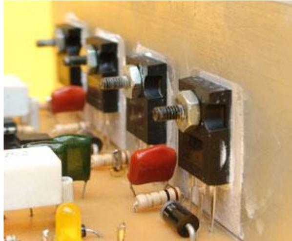
**Fig. 3.4.- Transistores TIP3055**
