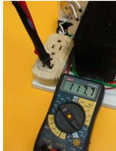
**Fig. 3.8.-** Voltaje del inversor
