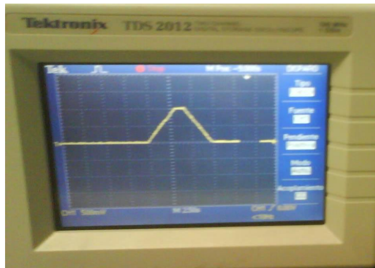
Señal que se genera la tarjeta DAQ
