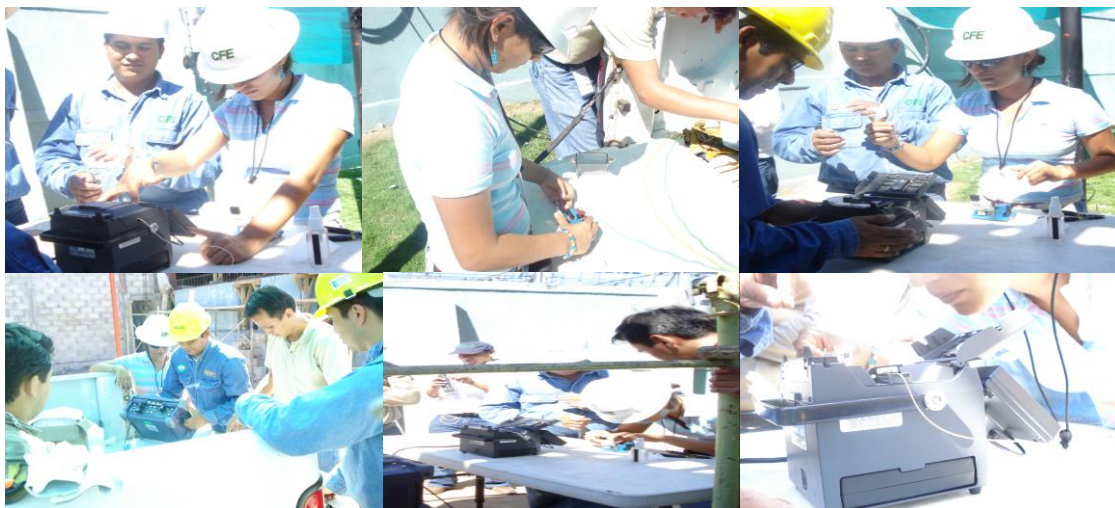
Fig.37.- Empalmes y pruebas de atenuación
