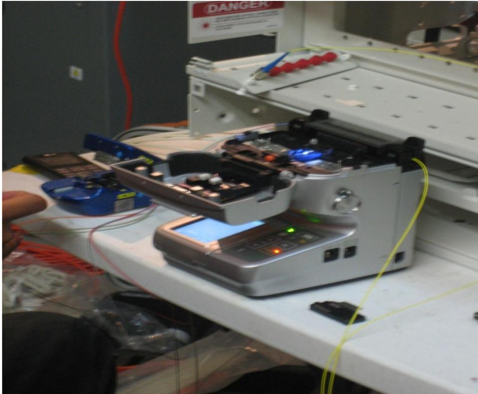
Esta actividad consiste en la realización de pruebas de atenuación del enlace con cable de fibra óptica instalado del edificio de distribución a subestación de San Cristóbal, conformándose por las tareas siguientes:
