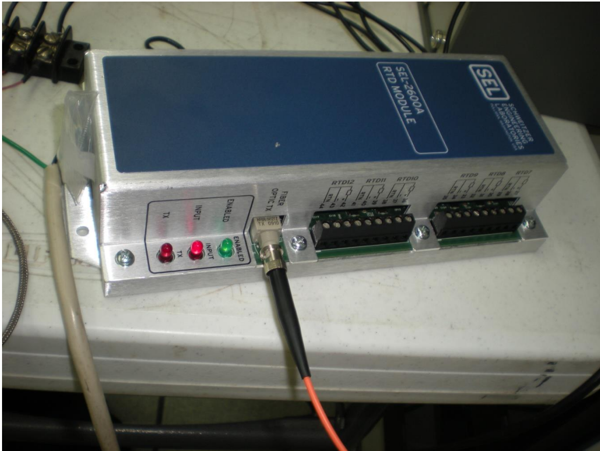
Figura 3.1.1: El módulo se encuentra equipado con un puerto de fibra óptica ST opción.
