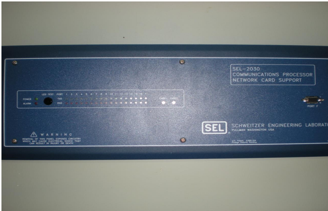
Figura 3.6: parte frontal del sel_2030.
